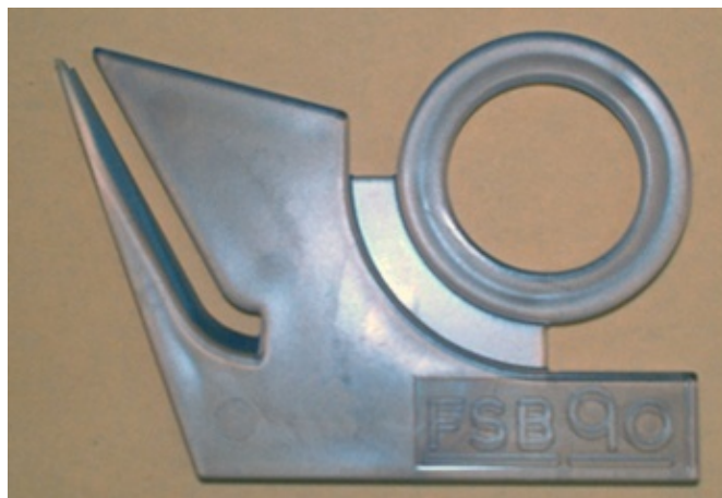
Slika 3.8 Otpresak sa vidljivim otiskom izbacivala
