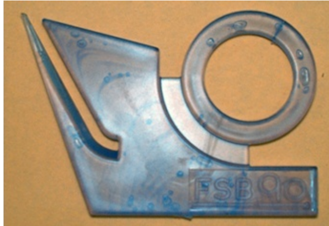
Slika 3.5 Otpresak sa mjehurićima zraka
