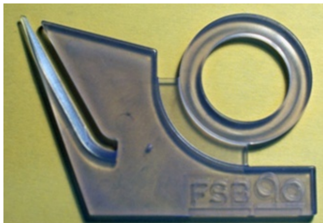
Slika 3.3 Otpresak sa uleknućima na površini
