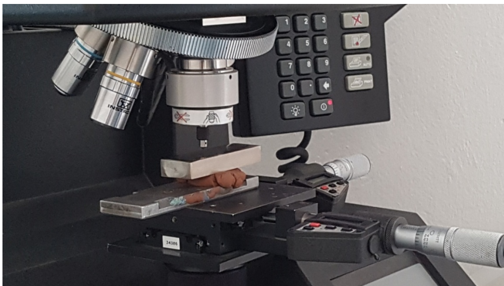
Slika 27. Uzorak postavljen na mikrotvrdomjer
