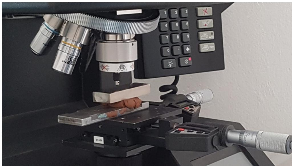
Slika 27. Uzorak postavljen na mikrotvrdomjer
