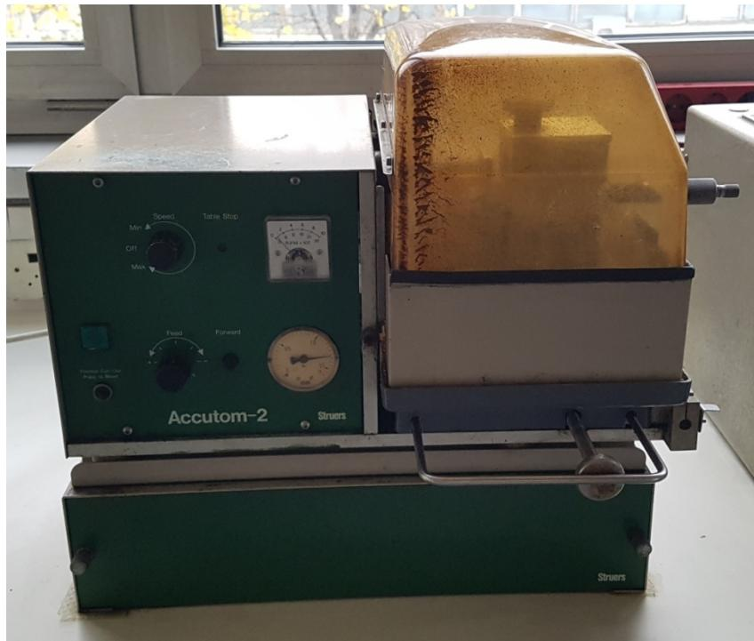
**Slika 35.** Pila za izrezivanje uzorka *Struers Accutom - 2*
