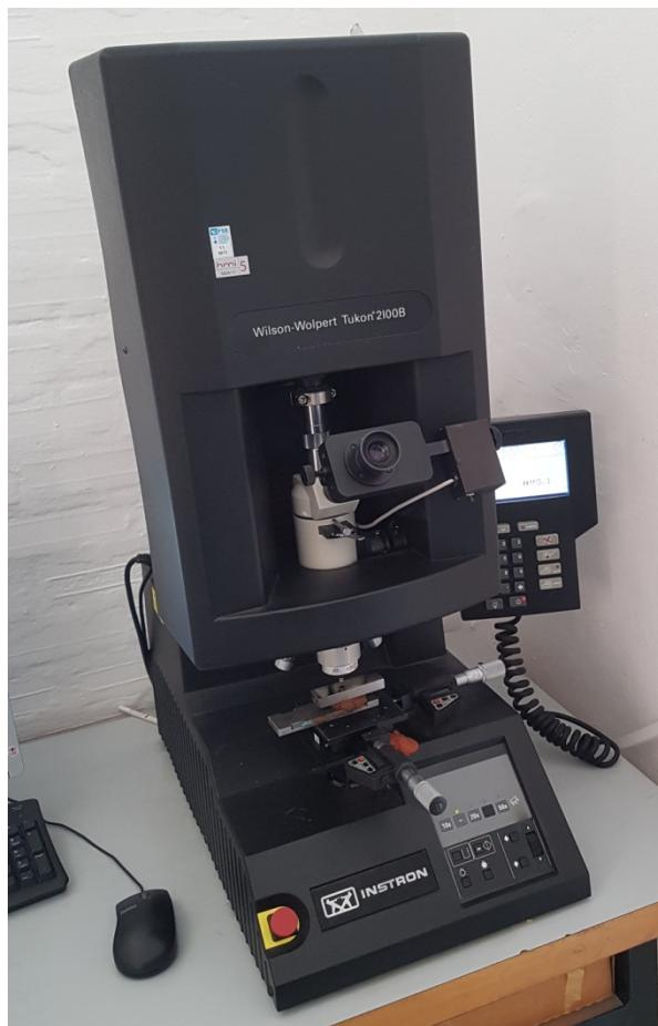
**Slika 26.** Mikrotvrdomjer *Wilson Wolpert Tukon 2100 B*
