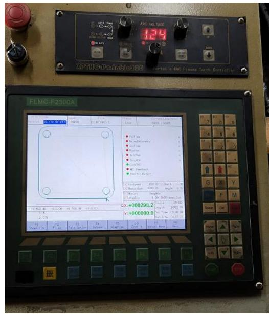
**Slika 28. Računalna jedinica CNC plazma stroja**
