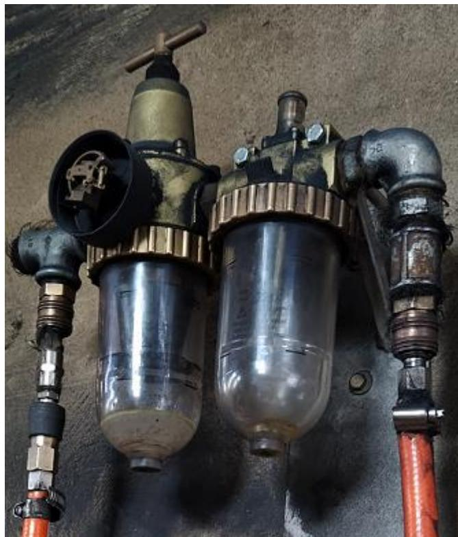
**Slika 30. Priprema za odvajanje vlage iz zraka**
