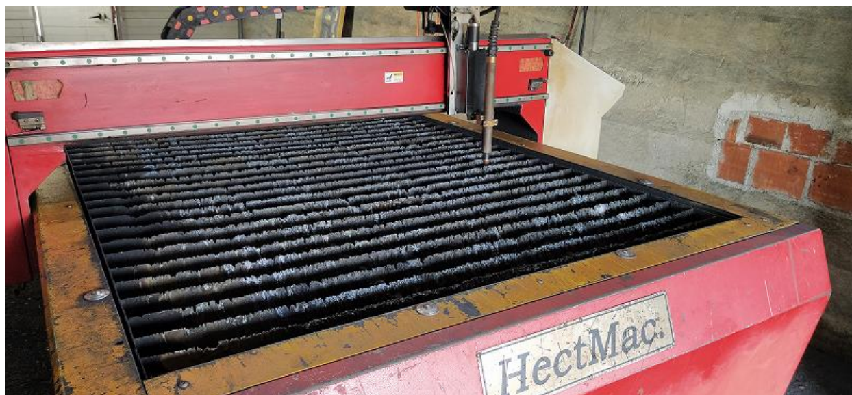
Slika 24. CNC plazma stroj u maloj hali poduzeća Medved Metali
