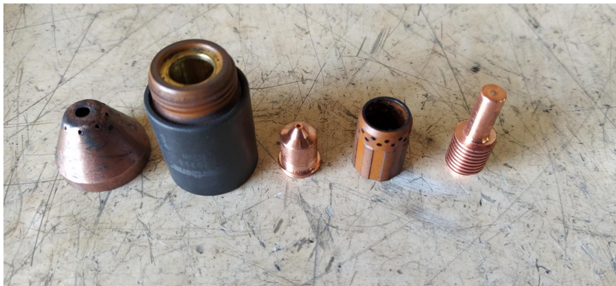
Slika 33. Potrošni dijelovi vrha gorionika Hypertherm T45m
