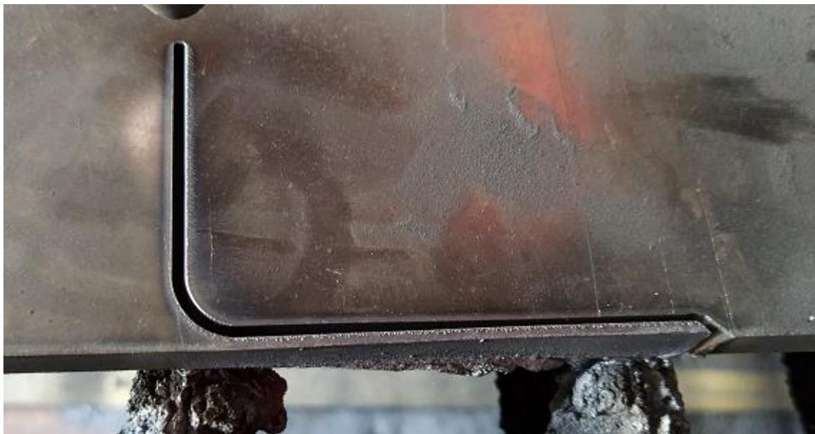
**Slika 16. Iniciranje rezanja na rubu ploče**
