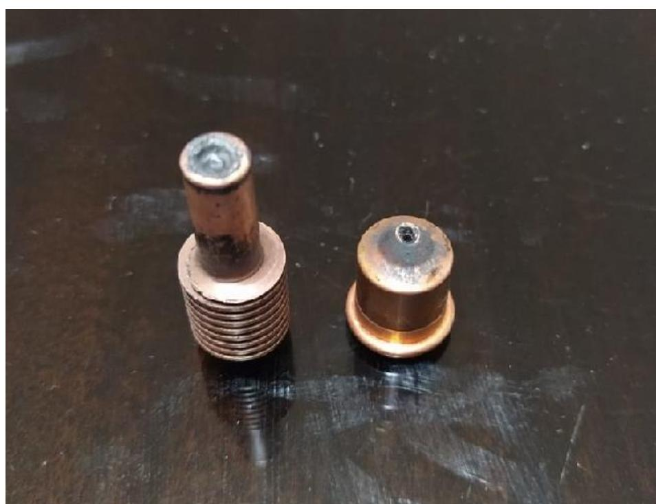
**Slika 19.** Uništena elektroda i sapnica
