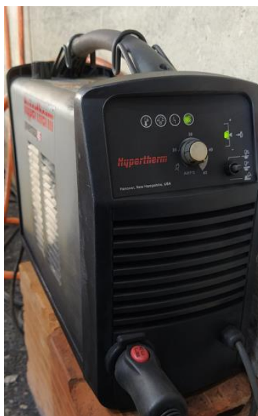
Slika 29. Napajanje Hypertherm Powermax45
