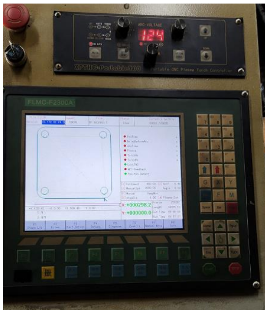
Slika 28. Računalna jedinica CNC plazma stroja
