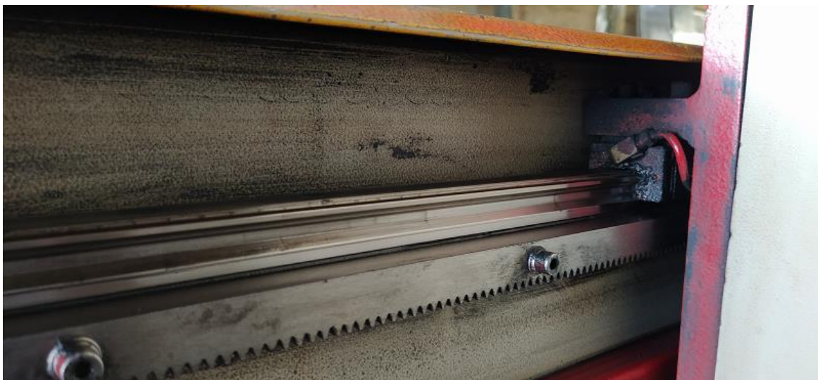
Slika 25. Vodilica i klizači CNC plazma stroja
