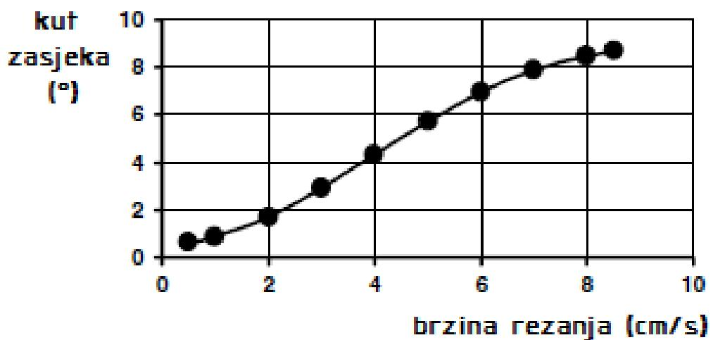
Slika 22. Ovisnost kuta zasječka o brzini rezanja za plazma rezanje zrakom [16]
