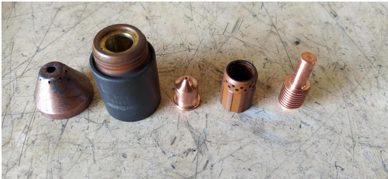
**Slika 33. Potrošni dijelovi vrha gorionika Hypertherm T45m**
