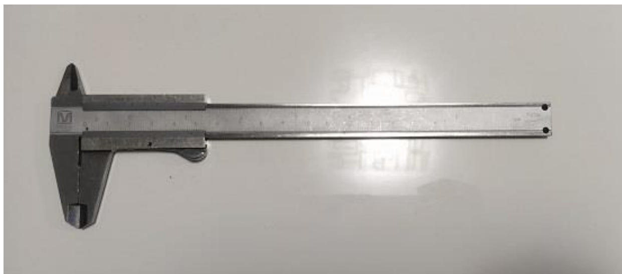
Slika 37. Pomična mjerka proizvođača Meba preciznosti 0,02 mm
