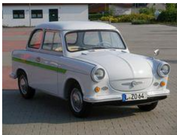
Slika 2.6. Krov, poklopac prtljažnika, poklopac motora, odbojnici i vrata Trabanta 600 od kompozita s polimernom matricom [19]
