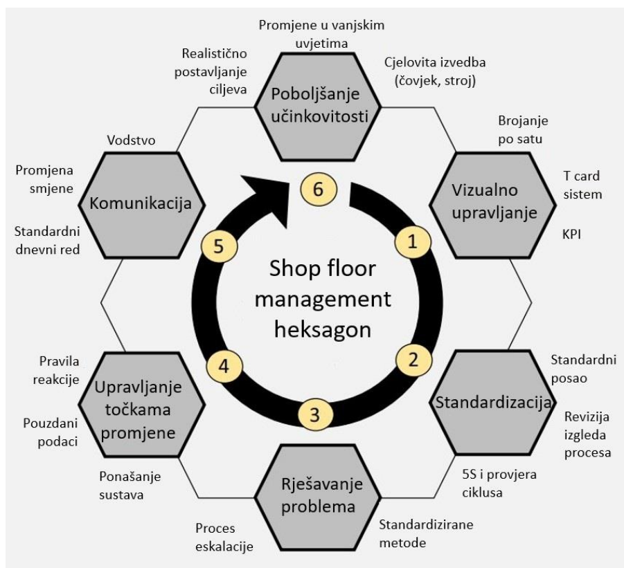
Slika 4. Model procesa SFM-a [10]
