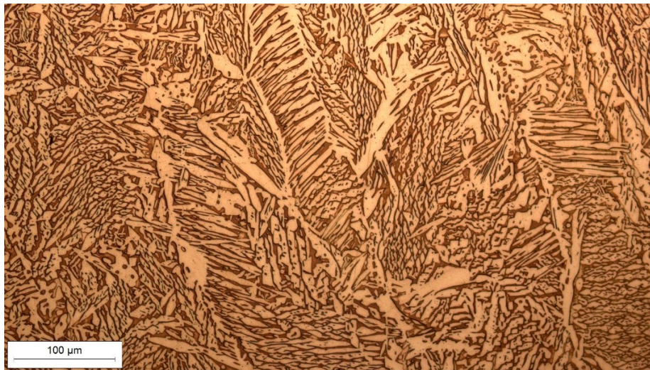
Slika 81. Mikrostruktura nakon homogenizacijskog žarenja, povećanje 200x
