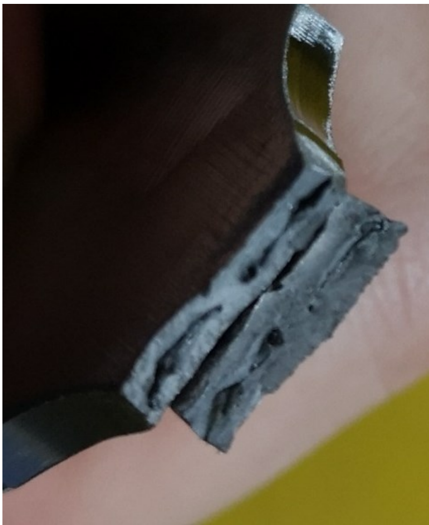
Slika 64. Navarivanje na mjestu prijeloma (H2)
