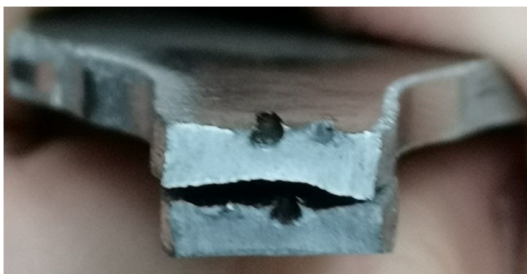
Slika 64. Navarivanje na mjestu prijeloma (H2)
