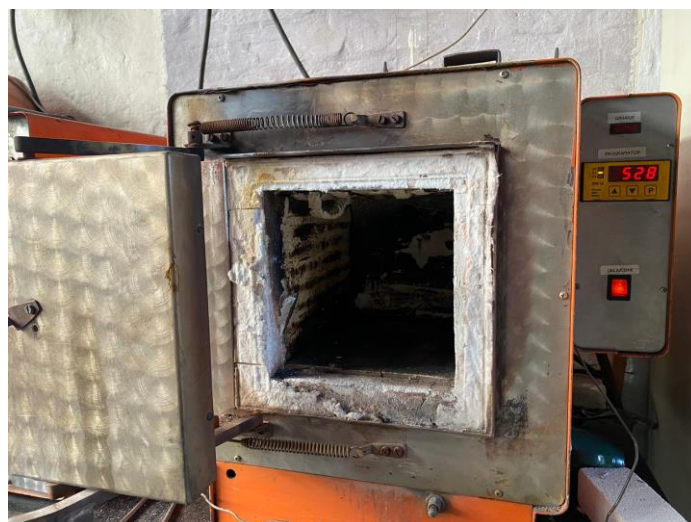
Slika 43. Peć za popuštanje čelika (525 °C; 180 °C)
