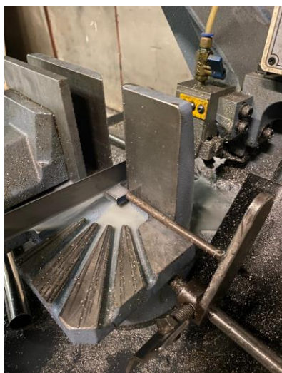
Slika 29. Rezanje na željene dimenzije na tračnoj pili
