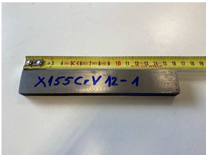
Slika 27. Komad čelika X155CrVMo12-1 od kojih su izrađeni uzorci
