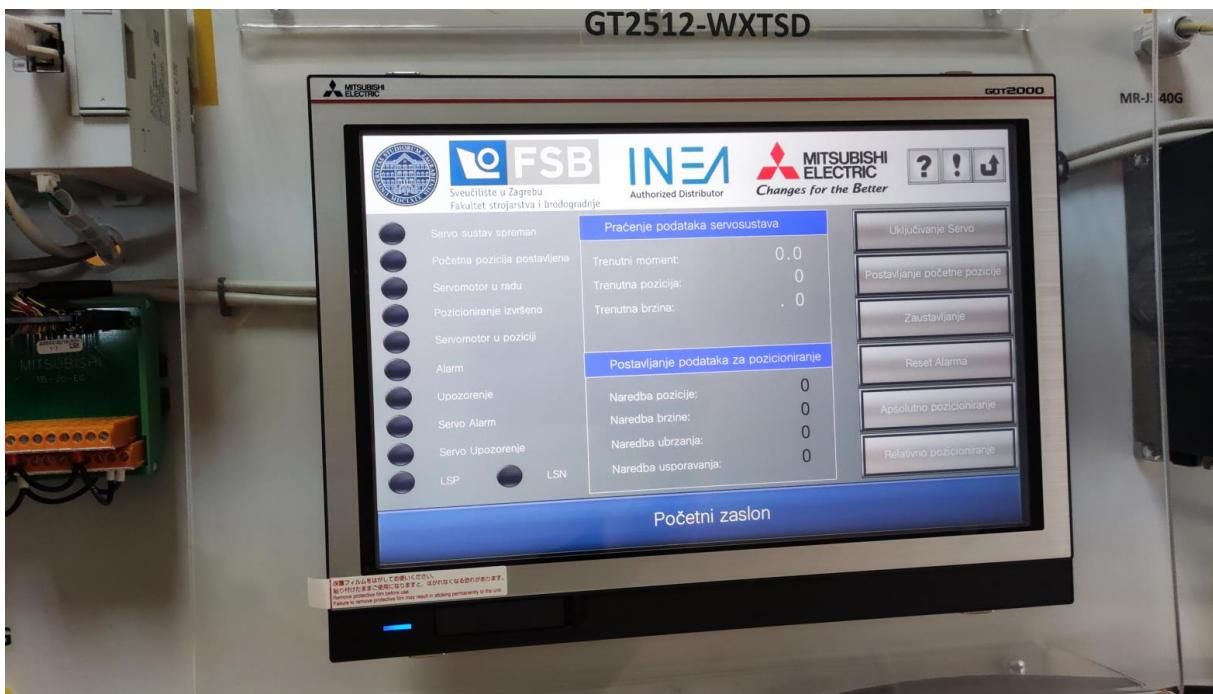
Slika 18. Prikaz regulacije pozicije sustava na HMI zaslonu
