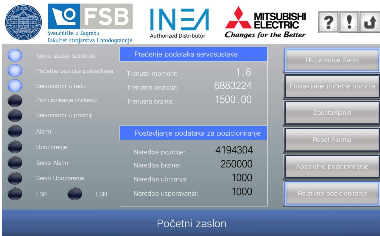
Slika 61. Relativno pozicioniranje u tijeku
