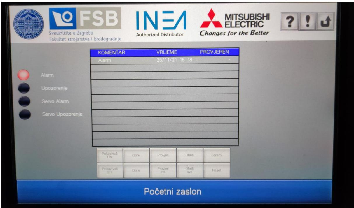
**Slika 68. Ispis alarma u tablici praćenja alarma na HMI-u**
