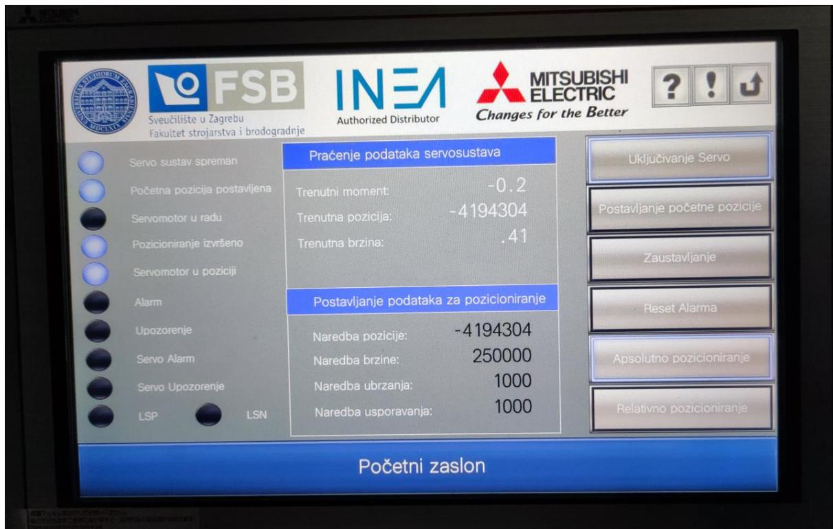
Slika 70. Apsolutno pozicioniranje izvršeno
