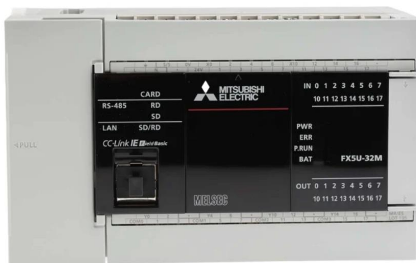
Slika 9. FX5U-32M programibilni logički kontroler [6]
