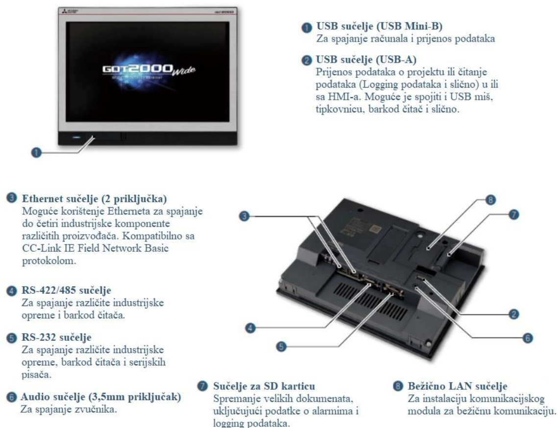
Slika 12. GT2512 WXTSD grafički operatorski terminal [8]
