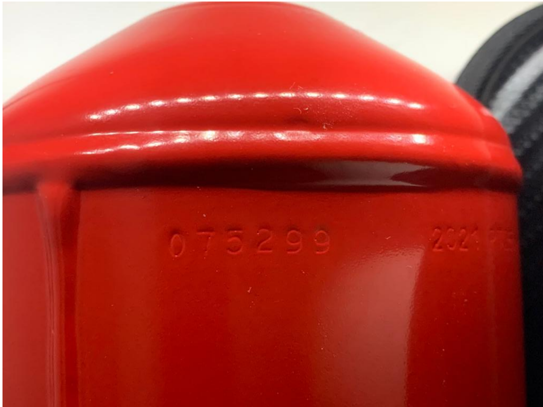
Slika 102. Primjer serijskog broja na spremniku vatrogasnog aparata - 2
