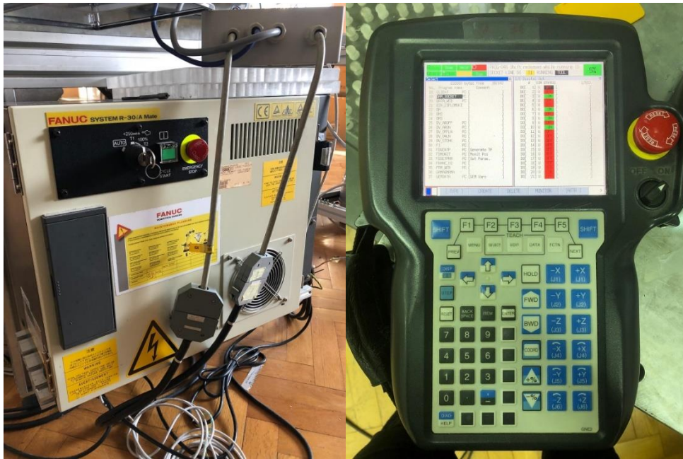
Slika 96. Fanuc R30iA Mate kontroler i privjesak za učenje (TP – Teach Pendant)
