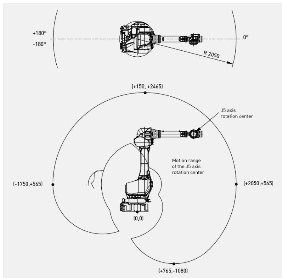
Slika 18. Radni prostor robota Fanuc M710iC-70 [3]
