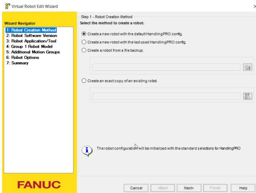
Slika 57. Otvaranje nove robotske célige u Roboguide-u
