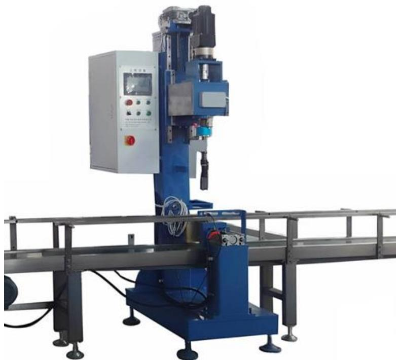
Slika 17. Stroj za automatsko stezanje ventila
