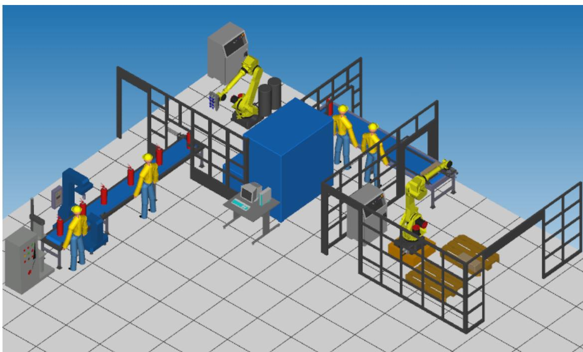
Slika 77. Proces završne montaže u bijeloj sobi - Roboguide
