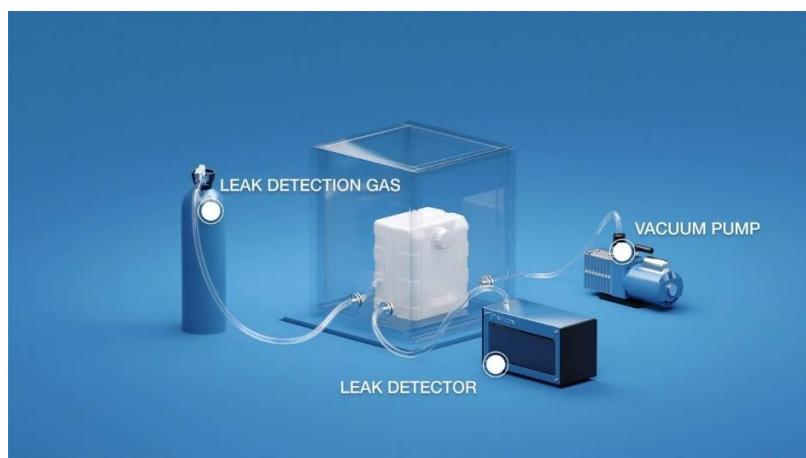
Slika 20. Postupak testiranja istjecanja helija [5]
