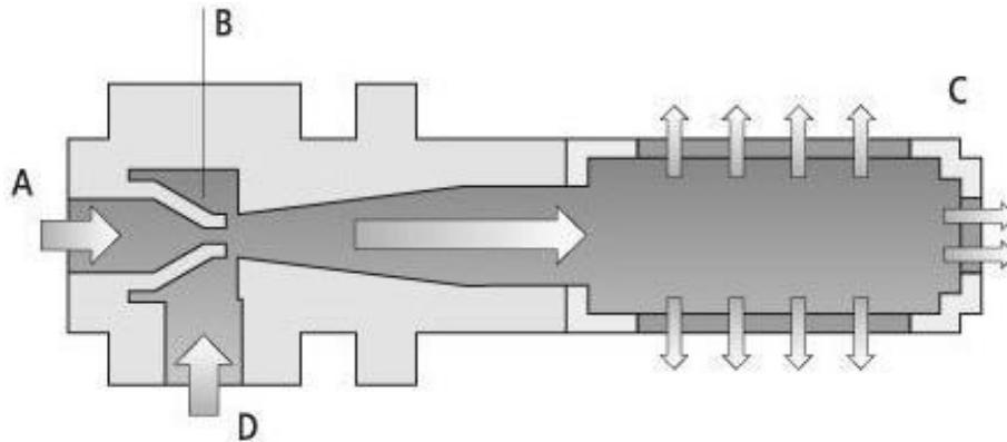
**Slika 25. Venturijev vakuum generator [9]**
