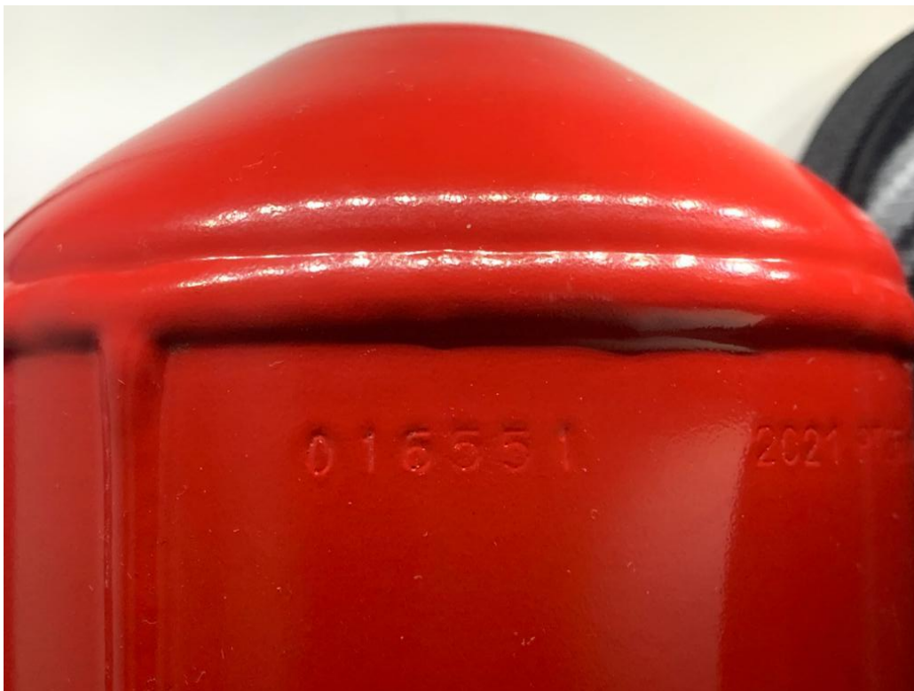
Slika 101. Primjer serijskog broja na spremniku vatrogasnog aparata
