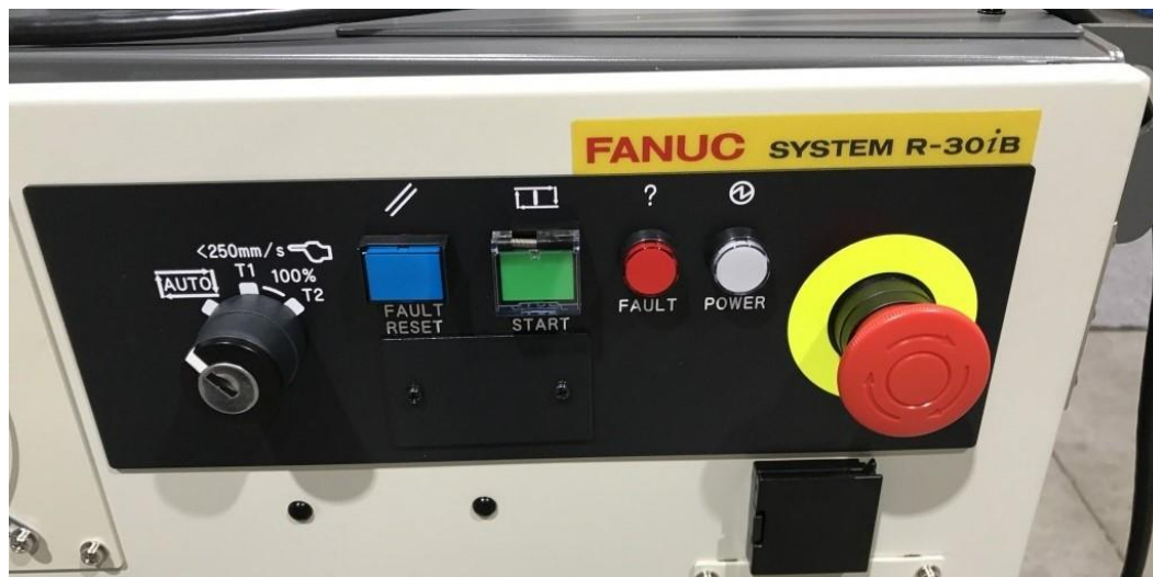
Slika 100. Postavljanje robota u automatski način rada – AUTO mode
