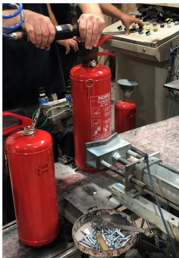
Slika 7. Stezanje ventila pneumatskim pištoljem
