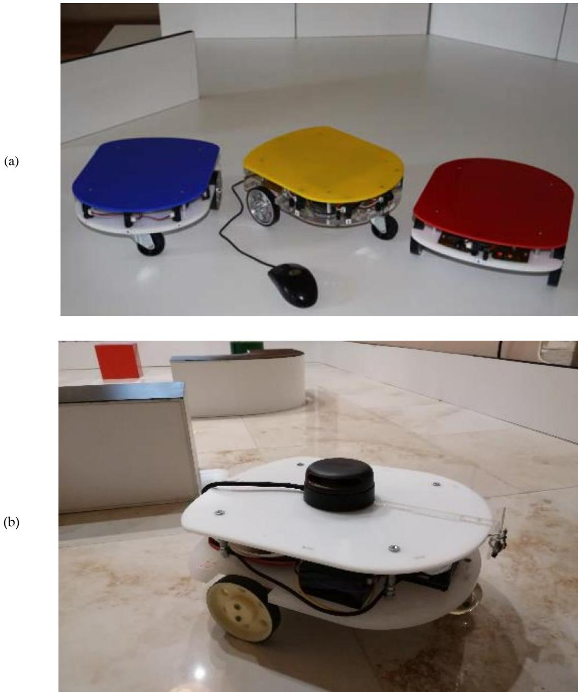
Slika 1. Mobilni roboti: (a) starija generacija opremljena IR senzorima daljine; (b) novija generacija opremljena laserskim senzorom daljine (LiDAR).
