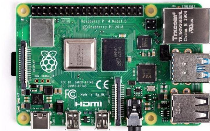
Slika 22. Raspberry Pi 4B SoC računalo.
