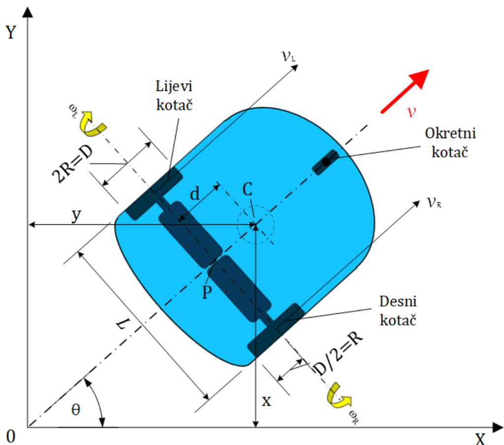
Slika 7. Kinematički model mobilnog robota diferencijalne strukture.
