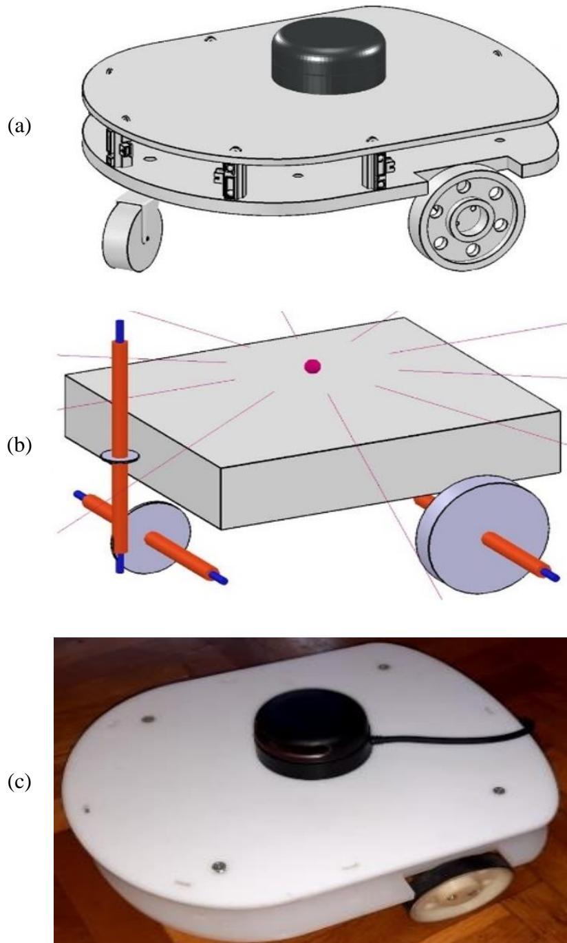
Slika 4. Razvoj mobilnog robota eMiR: (a) 3D CAD model eMiR; (b) dinamički model eMiR (CoppeliaSim programska platforma za virtualnu stvarnost); (c) izrađeni stvarni mobilni robot eMiR.
