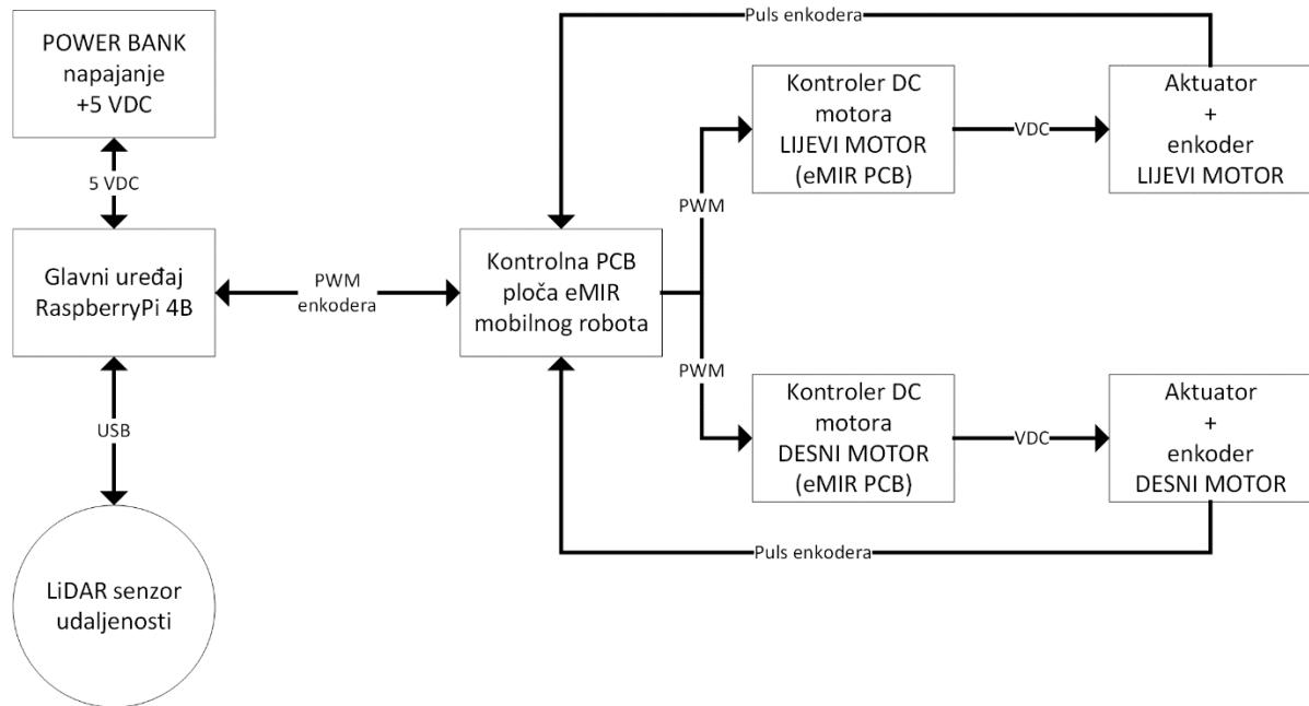
Slika 21. Blok dijagram elektroničkog sustava mobilnog robota.
