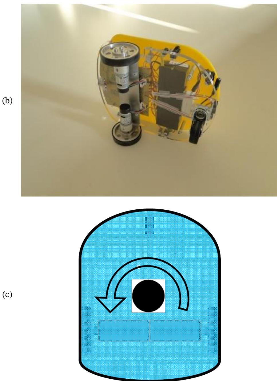
Slika 20. eMIR - mobilni robot diferencijalne kinematičke strukture: (a) kinematičke veličine; (b) izgled i raspored pogonskih motora i kotača; (c) položaj LiDAR-a na mobilnom robotu i smjer rotacije (točka C na slici 7).
