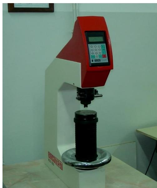
**Slika 66: Tvrdomjer Emco-Test N3D 000**
