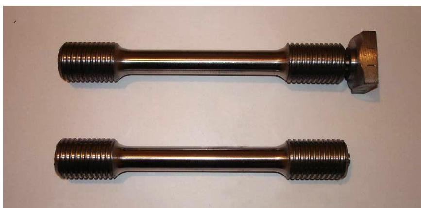
*Slika 63: Uzorak za statičko vlačno ispitivanje*
