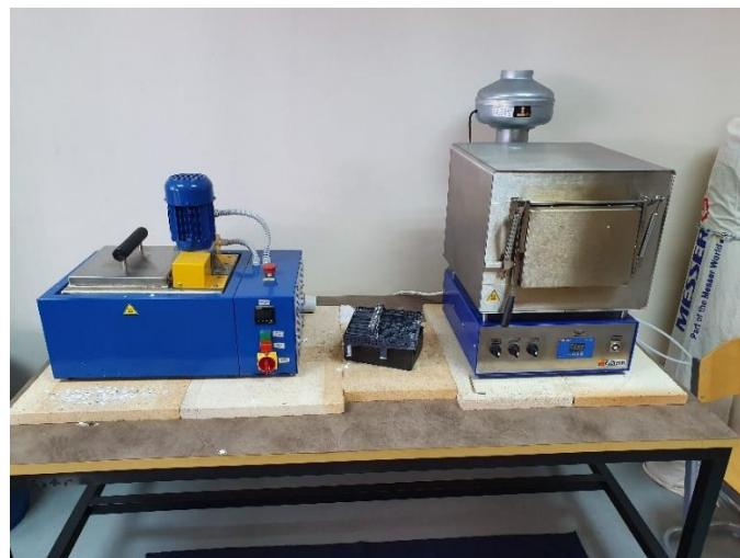
**Slika 140:** Kada s kupkom, uzorci nakon ADI postupka, peć
