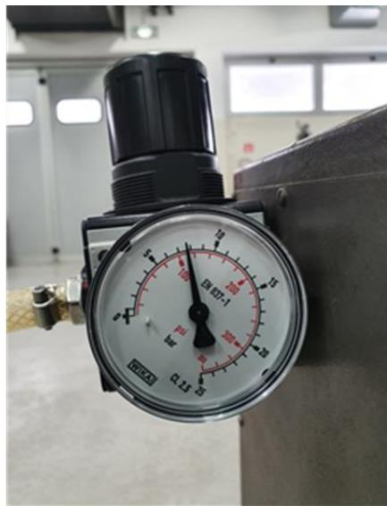
**Slika 142: Manometar na ulazu u napravu za kugličarenje**
