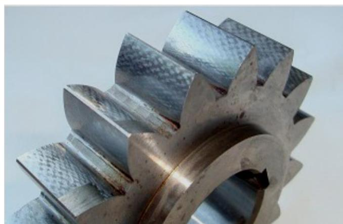
*Slika 52: Manji zupčanik obrađen Maagovim križnim brušenjem*
