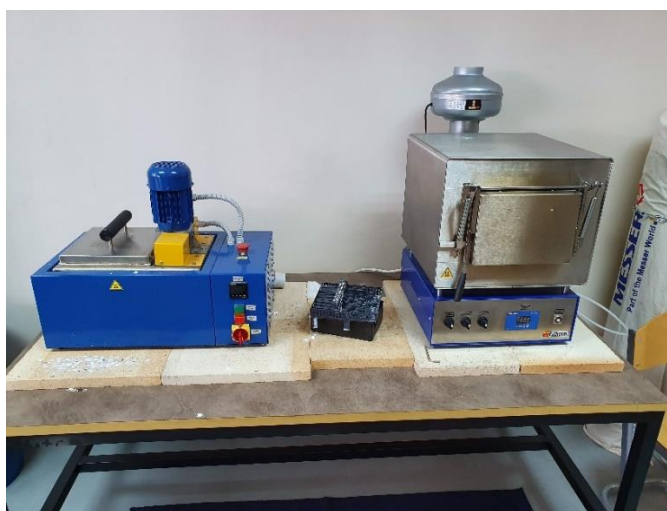
Slika 140: Kada s kupkom, uzorci nakon ADI postupka, peć
