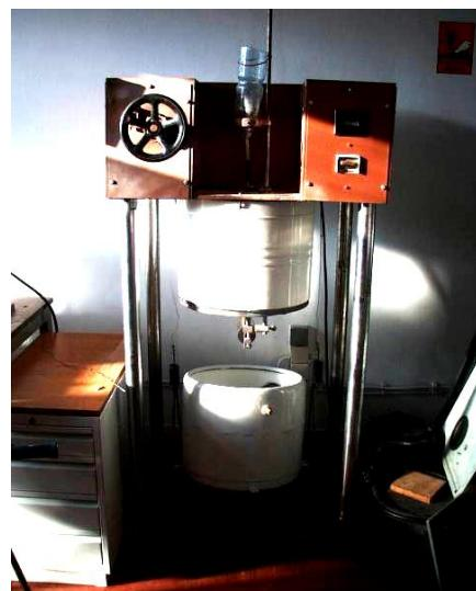
*Slika 98: Uredaj za ispitivanje otpornosti na eroziju suhim česticama*
