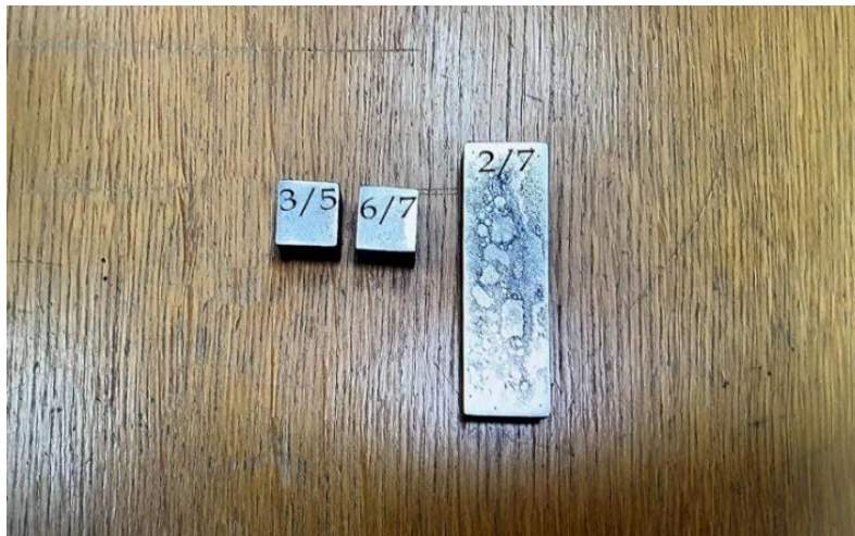
Slika 143: Uzorci na kojima je ispitana tvrdoća
