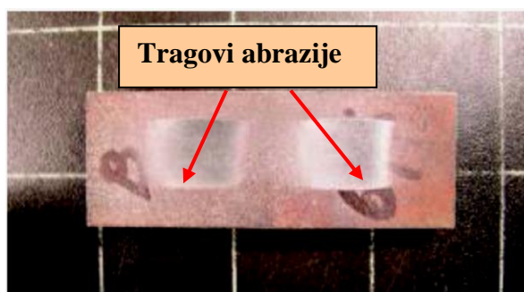
Slika 95: Izgled uzorka nakon ispitivanja otpornosti na abrazijsko trošenje[46]
