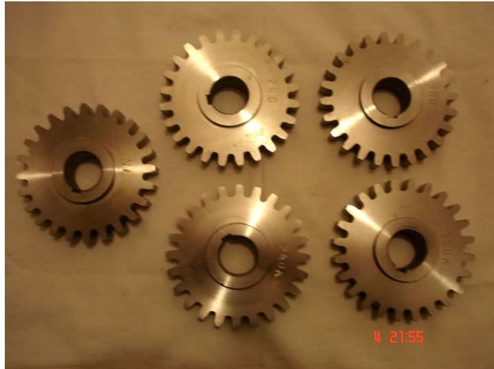
Slika 71: Zupčanici za FZG ispitivanje
