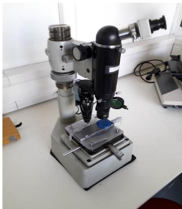
*Slika 145: Mikro tvrdomjer PMT-2*
