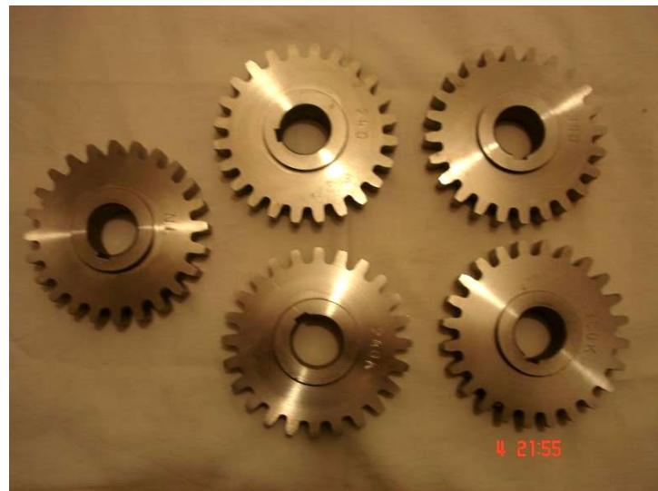
Slika 71: Zupčanici za FZG ispitivanje
