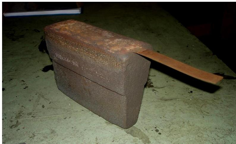
*Slika 56: Odljevak Y-proba*
