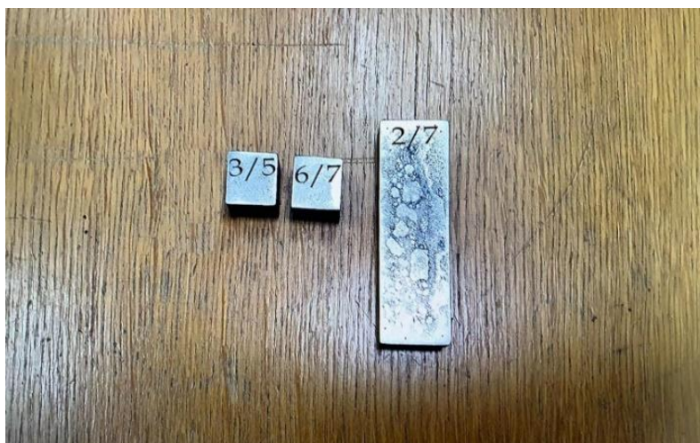
Slika 143: Uzorci na kojima je ispitana tvrdoća
