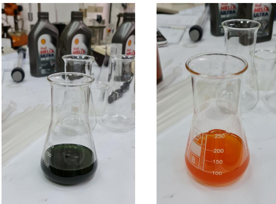
Slika 4. Prikaz mogućih obojenja uzorka prilikom utvrđivanja TAN-a
