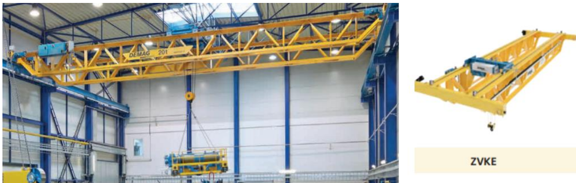
Slika 6. Rešetkasti dvogredni mosni granik [4]
