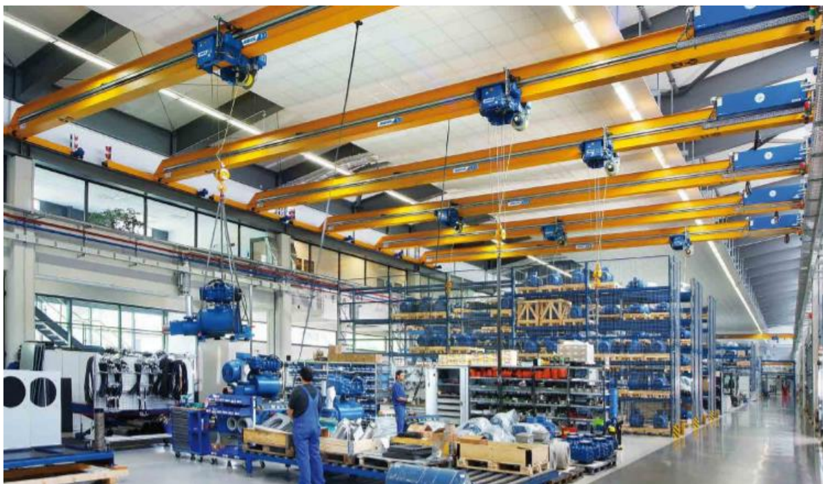
Slika 4. Jednogredni mosni granik tvrtke ABUS [1]
