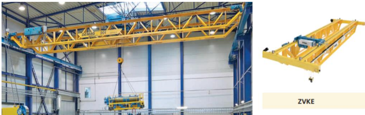
Slika 6. Rešetkasti dvogredni mosni granik [4]
