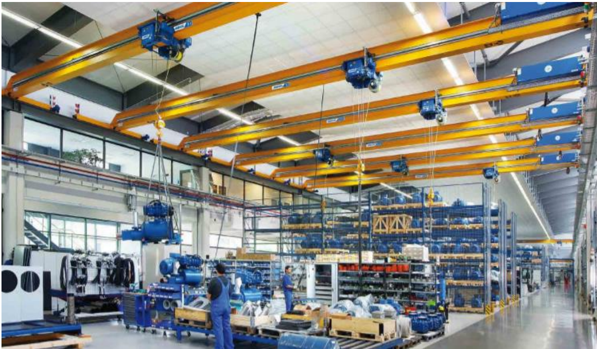
Slika 4. Jednogredni mosni granik tvrtke ABUS [1]
