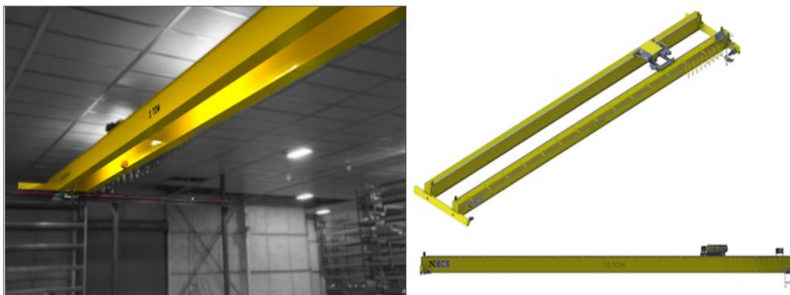
Slika 11. Dvogredni mosni granik iz kutijastih profila [9]
