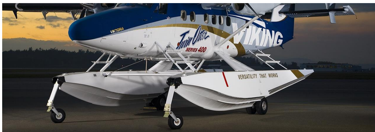
Slika 4. Podvozje izvedeno kao plovak [5]
