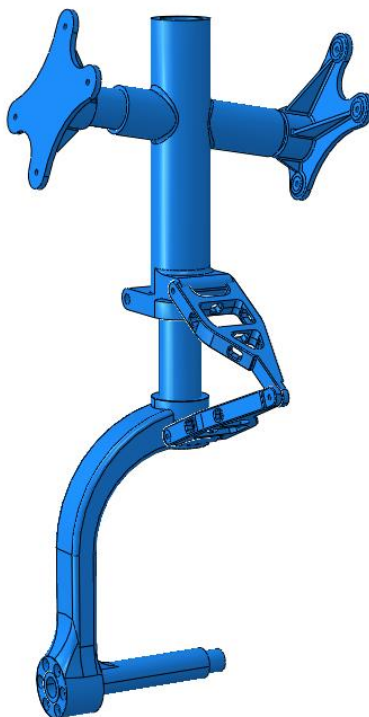
Slika 34. Numerički model podvozja
