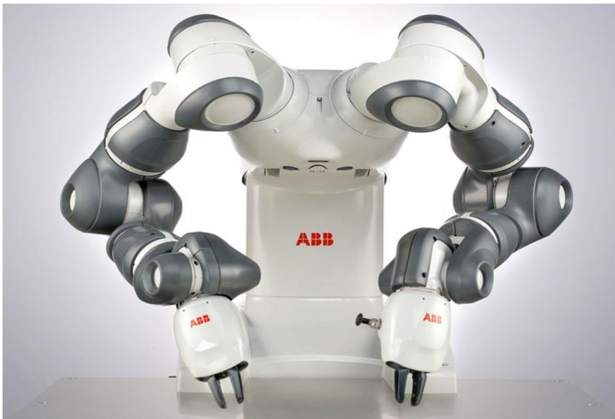
Slika 2. YuMi, kolaborativni robot s dvije ruke [4]
