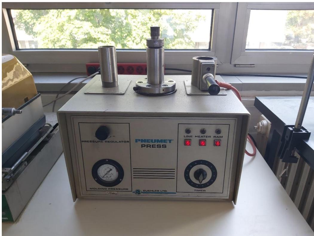
Slika 19 Pneumatska preša za zalijevanje uzorka
