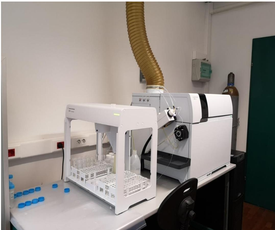
**Slika 30** Uredaj za masenu spektrometriju Agilent 7800
