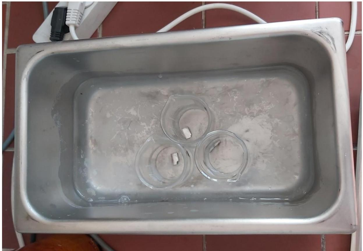
Slika 14 Čišćenje uzoraka u ultrazvučnoj kupelji
