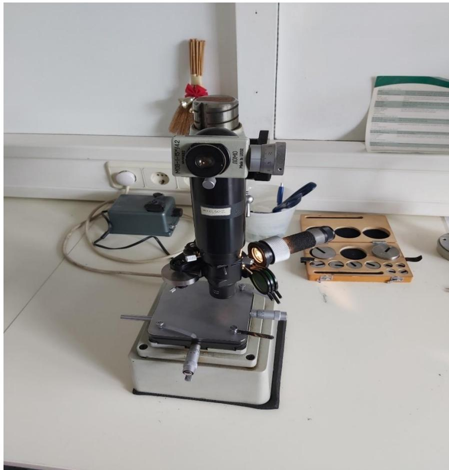
Slika 29 Mikrotvrdomjer oznake PMT-3
