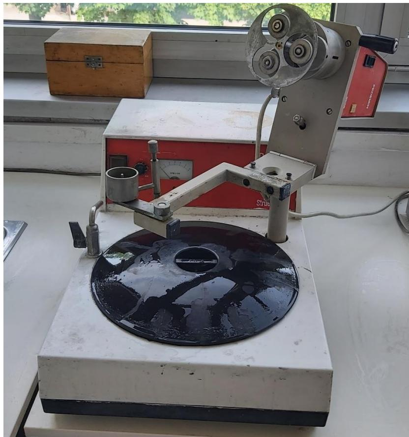
**Slika 22 Struers DAP-V uređaj za poliranje**
