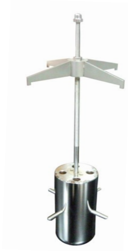
Slika 2. Primjer izotermalnog bloka termostatiranih kupki
