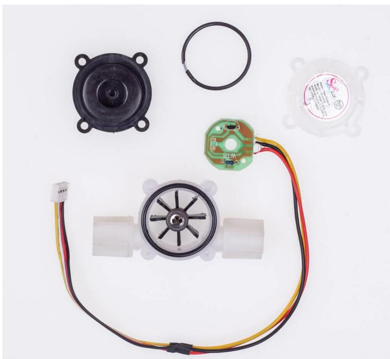
Slika 6 Senzor protoka [14]
