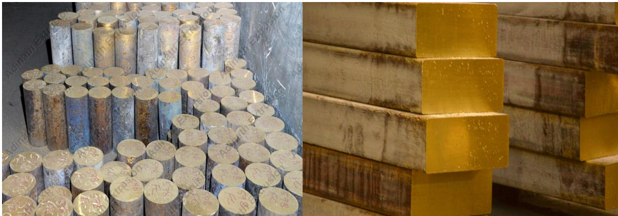
Slika 4. Mjedene gredice [20] (lijevo) i ploče [21] (desno)
