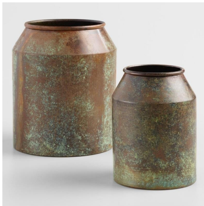
Slika 3. Mjedeni predmeti sa izraženim slojem patine [19]
