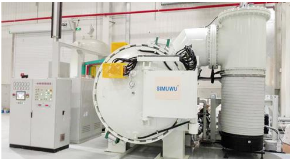
Slika 10. Vakuumska peć za lemljenje pri visokim temperaturama [27]
