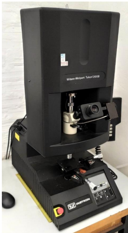
Slika 22. Uređaj za mjerenje mikrotvrdoće Tukon 2100B
