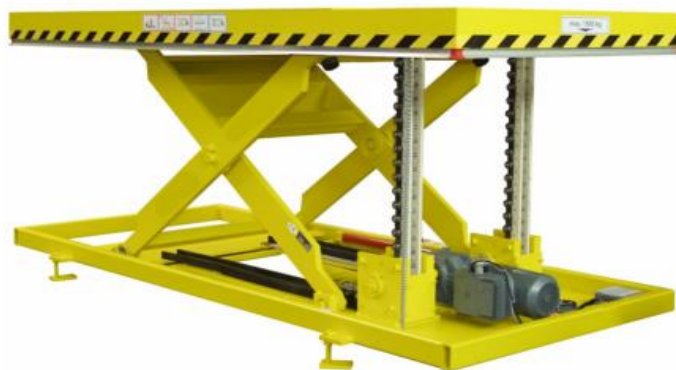
Slika 19. Podizna platforma pogonjena mehanizmom s lancem
