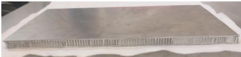
**Slika 40. Oblik sendvič konstrukcije nakon slaganja**
