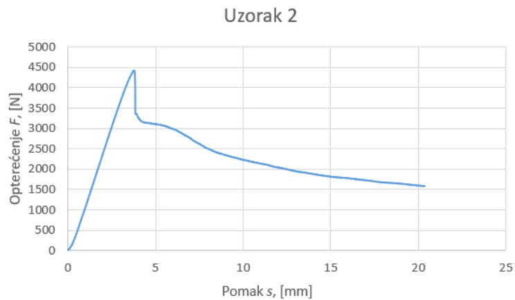
Slika 54. Dijagram sila-pomak 2. uzorka
