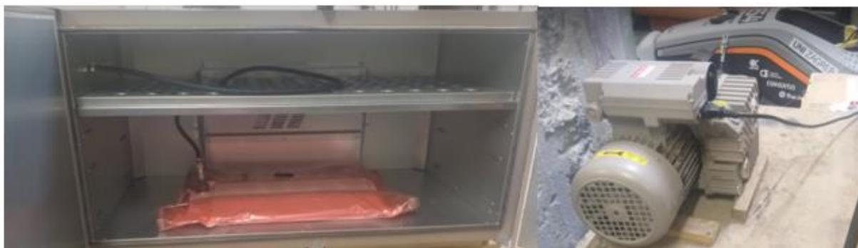
**Slika 41. Proizvod pod vakuumom u pećnici**
