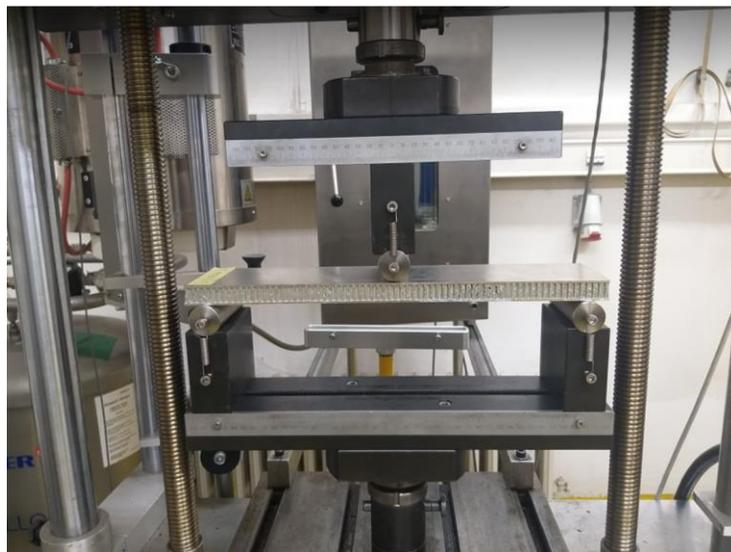
**Slika 45. Postavljanje uzoraka na kidalicu**
