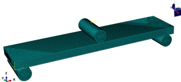
Slika 30. Diskretizirani prvi numerički model sa konačnim elementima
