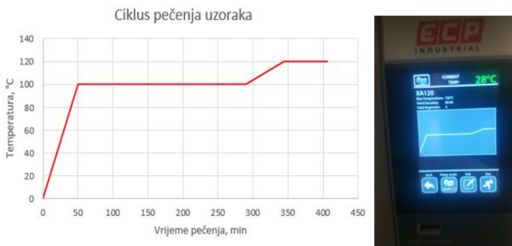
Slika 42. Dijagram temperatura-vrijeme kod ciklusa pečenja uzoraka
