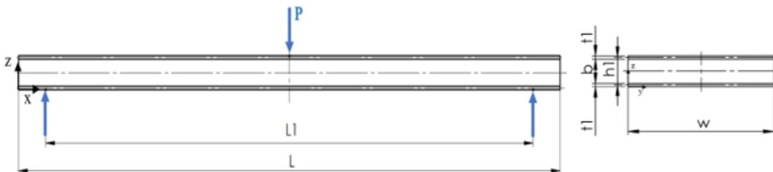
Slika 25. Dimenzije sendvič konstrukcije kod savijanja u tri točke
