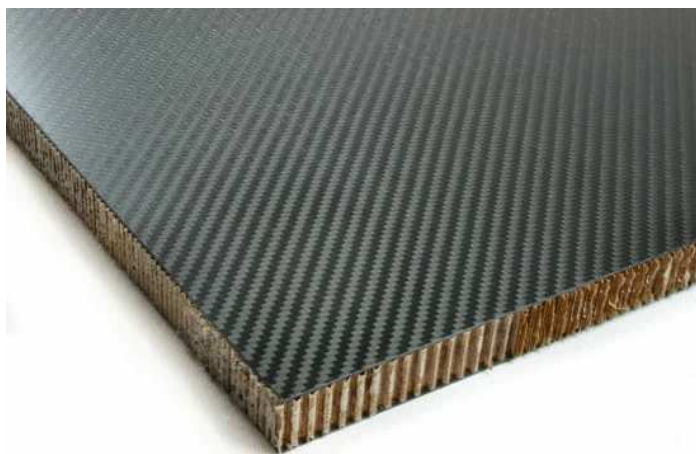
Slika 9. Nomex i CFRP sandwich[11]
