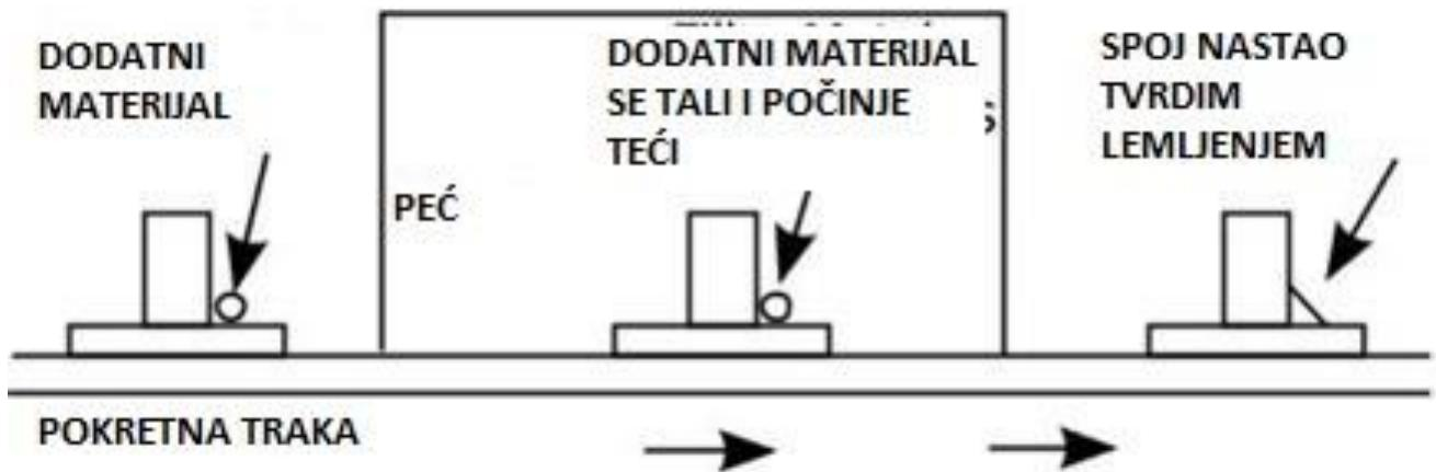
**Slika 17 Primjer korištenja tvrdog lemljenja u masovnoj proizvodnji [18]**
