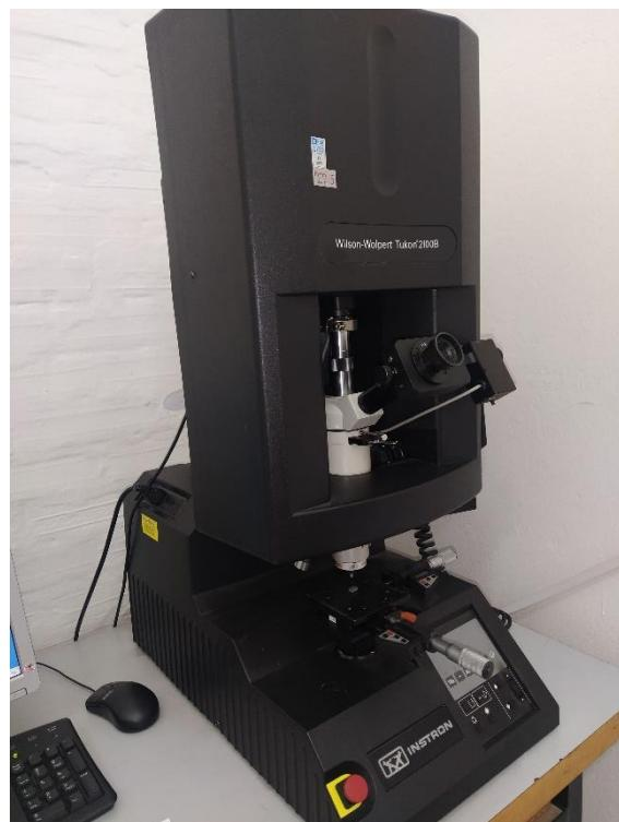
**Slika 30 Uređaj za mjerenje tvrdoće Tukon 2100b**
