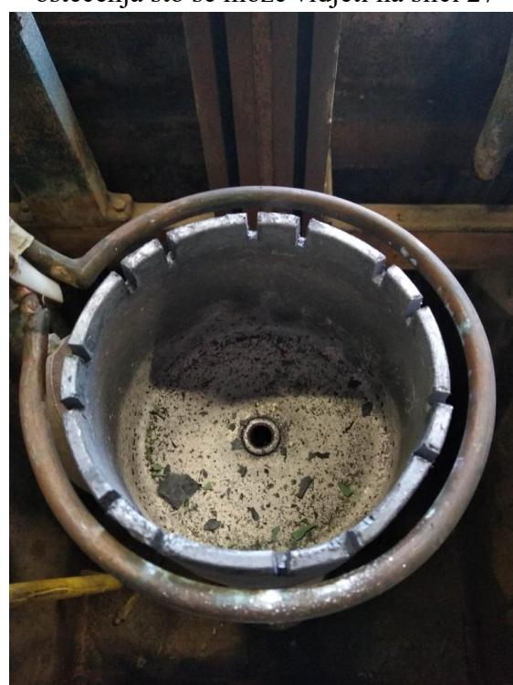
**Slika 27 Kruna nakon uklanjanja oštice**
