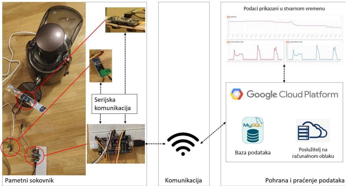
Slika 4.3. Apstraktan prikaz arhitekture digitalnog blizanca
