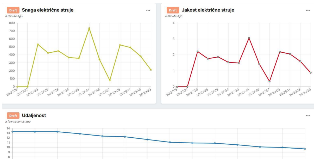
Slika 5.4. Vizualizacija očitanih vrijednosti senzora za grejp
