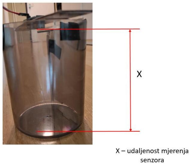
Slika 4.13. Prikaz mjerjenje udaljenosti senzora
