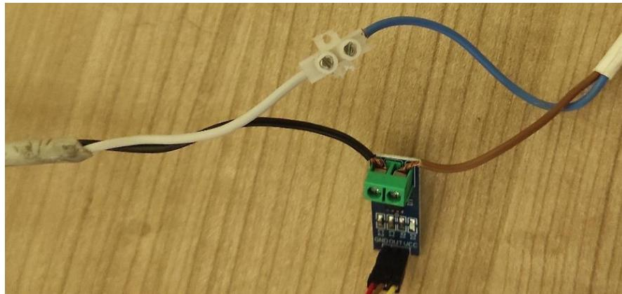
Slika 4.12. Integracija senzora u strujni krug
