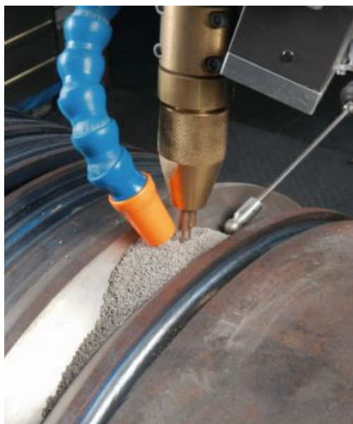
Slika 7. Zavarivanje pod zaštitom praška [18]
