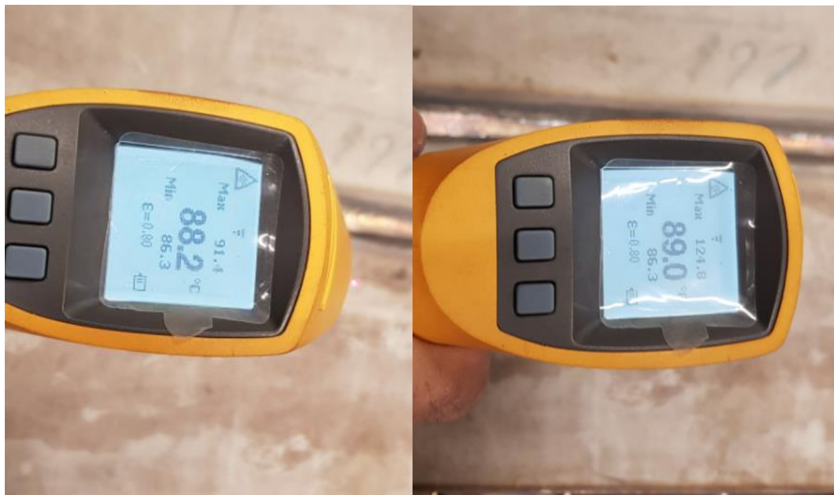
Slika 14. Kontrola međuslojne temperature
