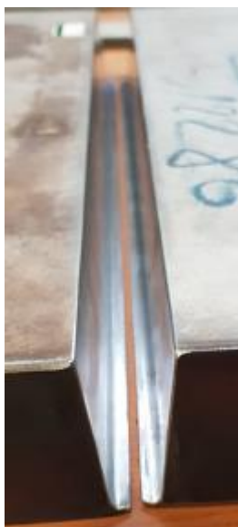
Slika 12. U-priprema radnog komada
