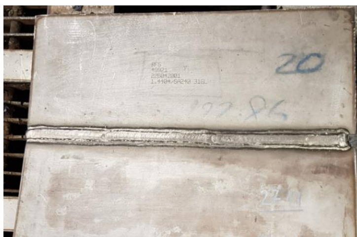
Slika 17. Zavareni uzorak materijala X2CrNiMo17-12-2
