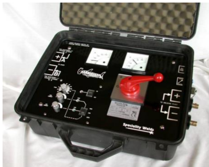
Slika 32. Izgled upravljačke ploče za podešavanje parametara zavarivanja [32]
