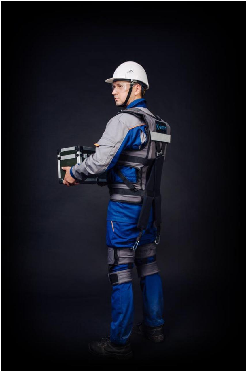
Slika 28. Pasivni egzoskelet X-Soft tvrtke Exorise [17]
