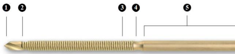
Slika 30. Samobušeci Schanzov vijak: 1 – svrdleni vrh, 2 – konus, 3 – simetrični navoj, 4 – obli prijelaz, 5 – standardna osovina [53]
