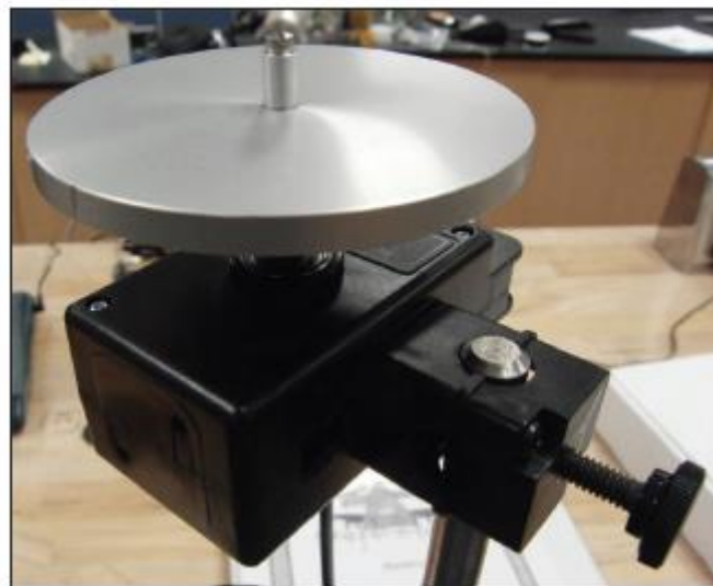
Slika 20. Sustav s dva rotacijska diska (na slici prikazan jedan rotacijski disk i senzor pokreta) [10]
