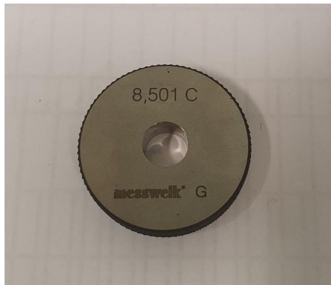
Slika 12. Mjerni kontrolni prsten promjera \varnothing 8,5 mm
