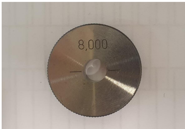
Slika 11. Mjerni kontrolni prsten promjera \emptyset 8 mm
