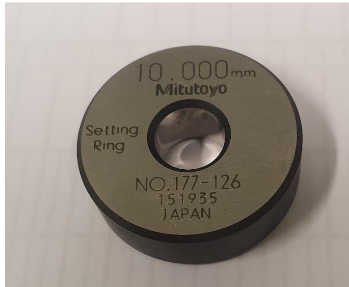
Slika 15. Mjerni kontrolni prsten promjera \varnothing 10 mm
