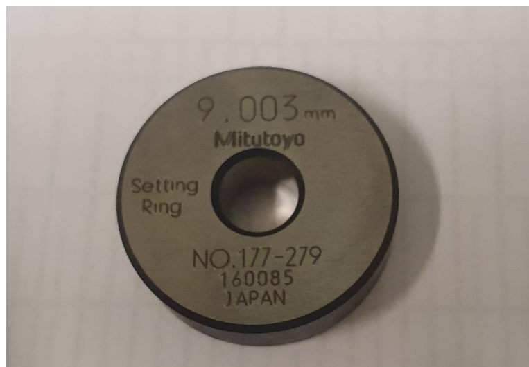
Slika 13. Mjerni kontrolni prsten promjera \varnothing 9 mm
