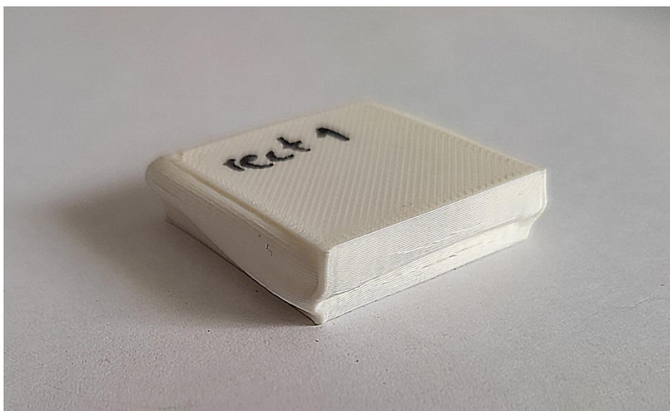
Slika 16. - Izgled epruvete nakon testiranja
