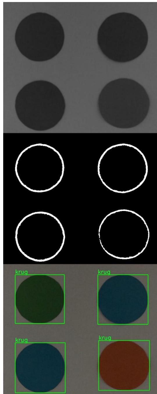
**Slika 21. Detekcija krugova koristeći Tresholding i aproksimaciju kontura u tamnjem okruženju**
