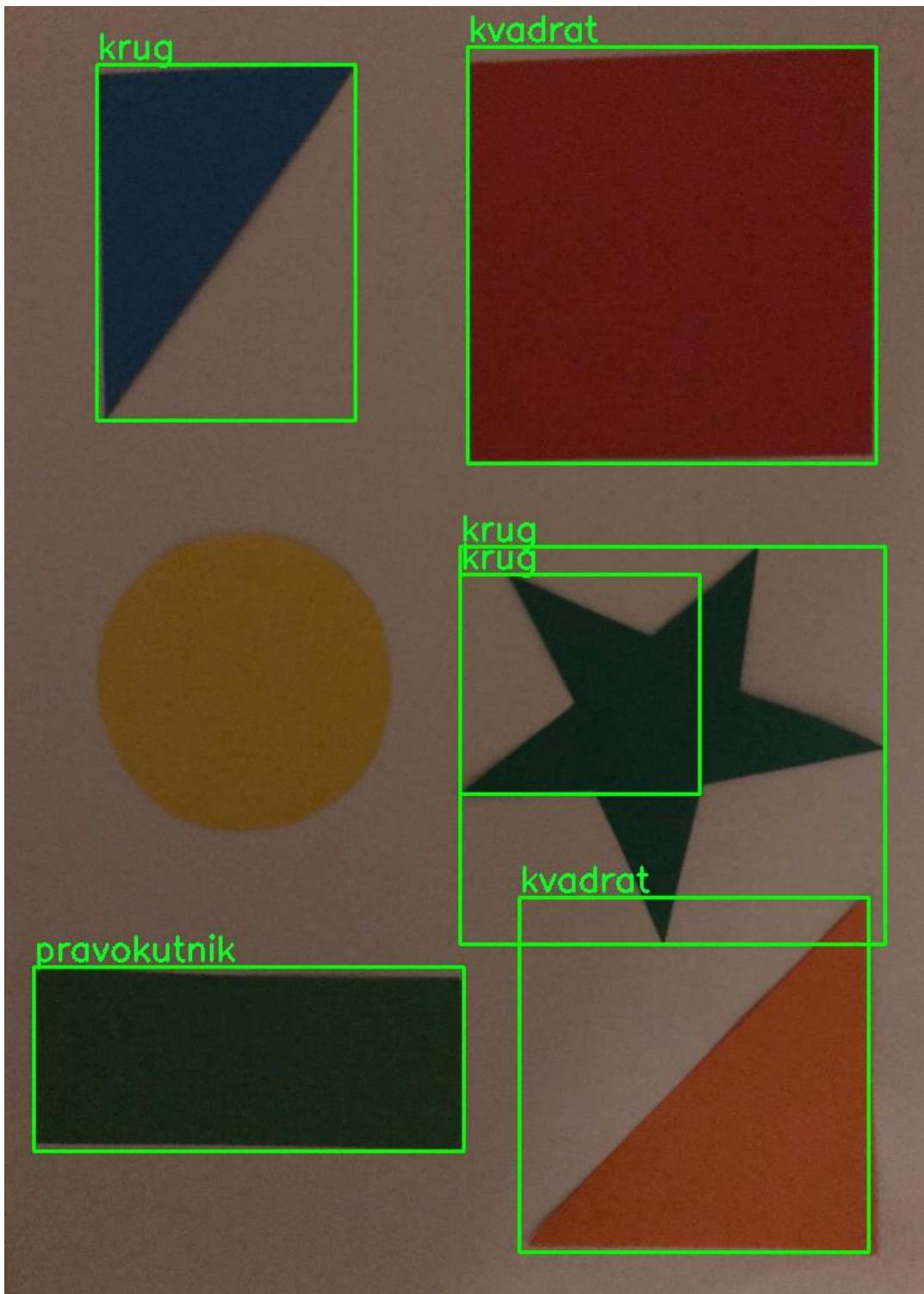
**Slika 25. Detekcija objekata koristeći Cannyjev algoritam i aproksimaciju kontura u tamnjem okruženju**
