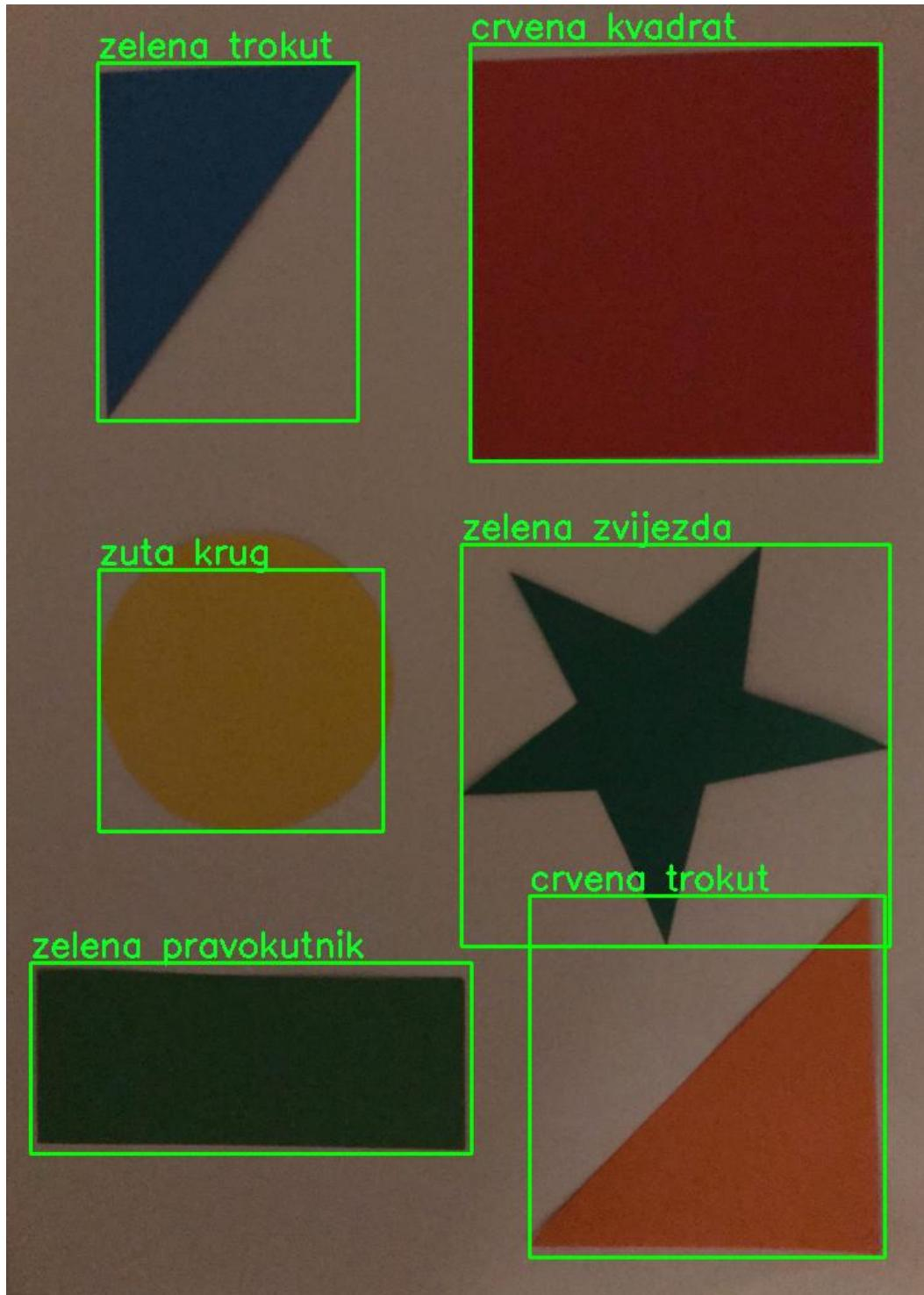
**Slika 24. Detekcija objekata koristeći Tresholding i aproksimaciju kontura u tamnjem okruženju**
