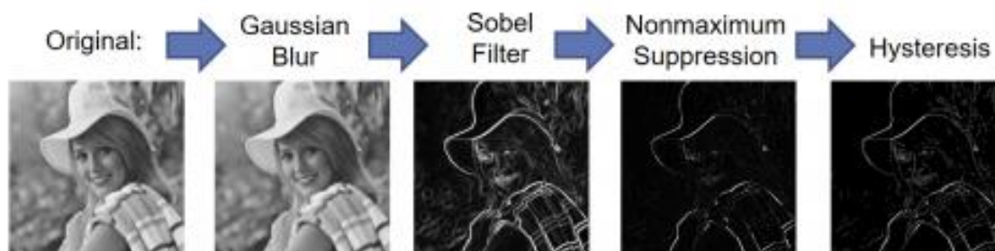
Slika 13. Osnovni koraci Cannyjevog algoritma [16]
