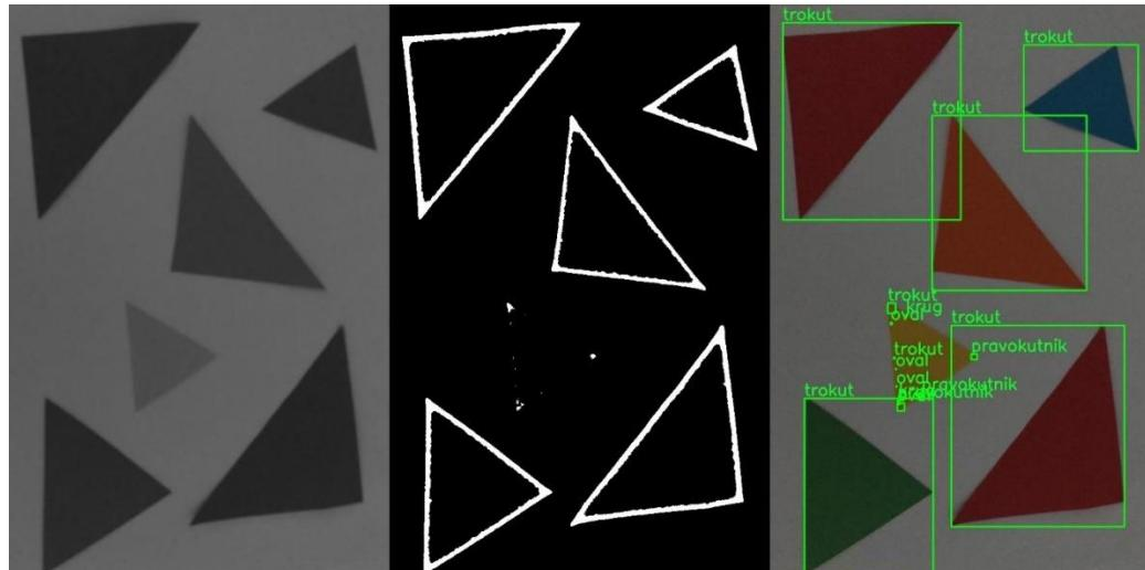
Slika 22. Neuspjela detekcija trokuta koristeći Tresholding i aproksimaciju kontura u tamnjem okruženju
