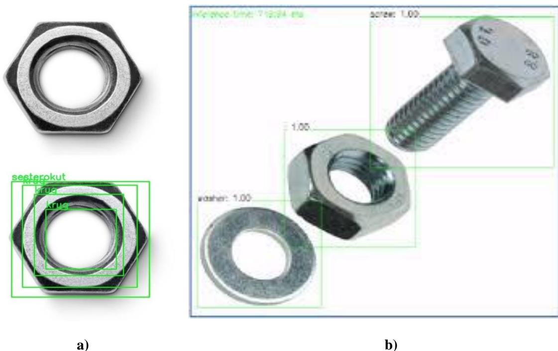
**Slika 29. Detekcija a) matice pomoću Thresholding metode i aproksimacije kontura b) matice, vijka i podložne pločice pomoću neuronskih mreža**
