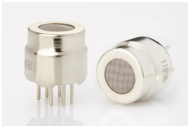
Slika 15. Senzor ugljikovog dioksida MG811
