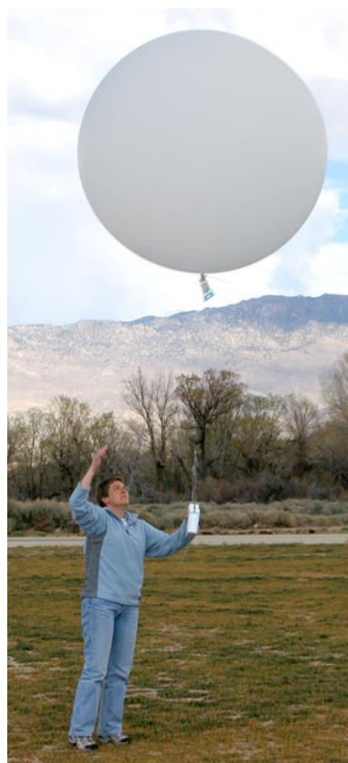
Slika 2. Radiosondažni balon
