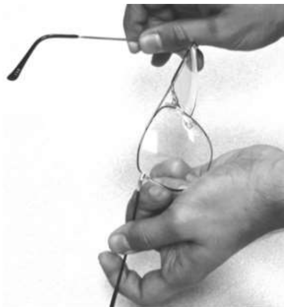
Slika 15. Okvir naočala pod pseudoelastičnim efektom [19]
