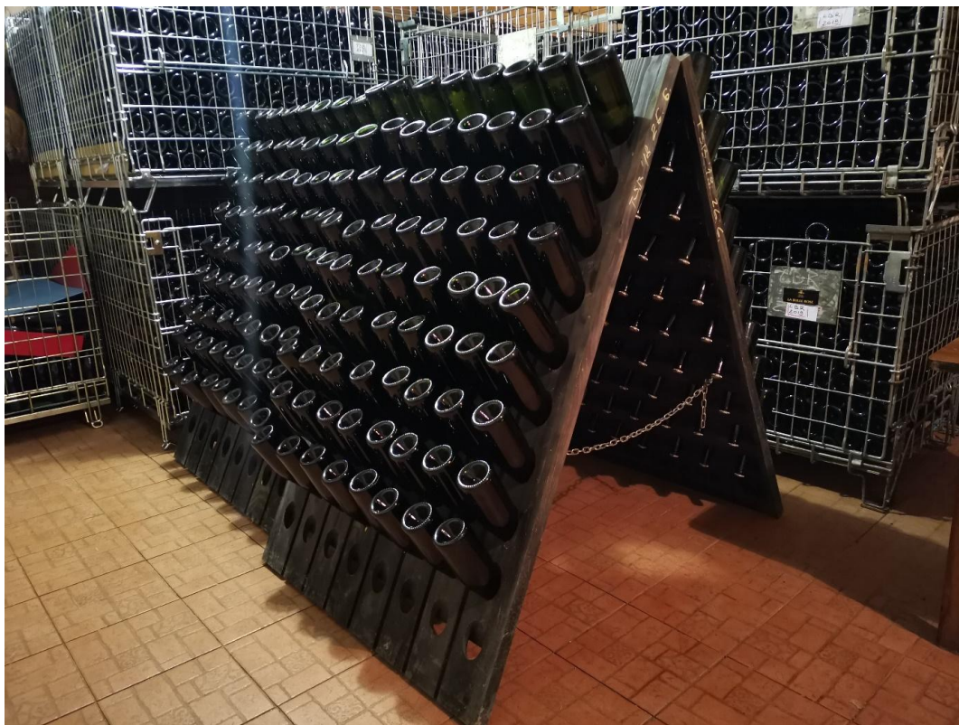
Slika 7. Stalci pupitres kapaciteta 300 boca
