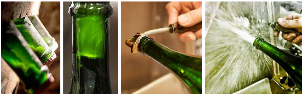
Slika 12. Proces ručne degoržacije pjenušca [42]
