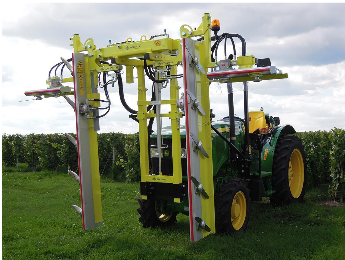
Slika 5. Stroj za zelenu rezidbu proizvođača Collard [32]
