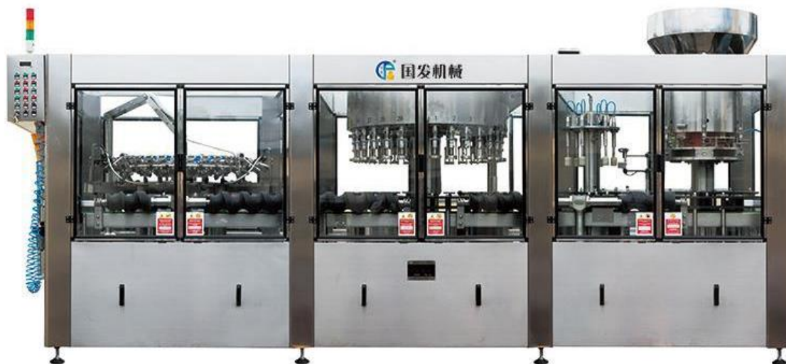
Slika 6. Automatski stroj za punjenje boca proizvođača Qingzhou [63]
