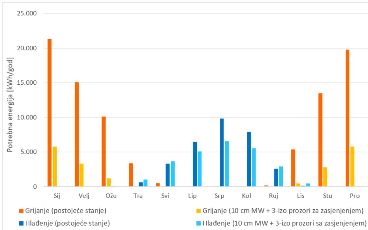
Slika 25. Usporedba postojećeg/referentnog stanja i konačnog stanja ovojnica zgrade
