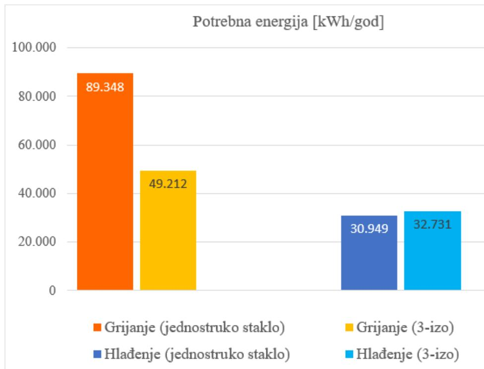
Slika 15. Usporedba potrebne energije između prozora s jednostrukim stakлом i 3-izo prozora
