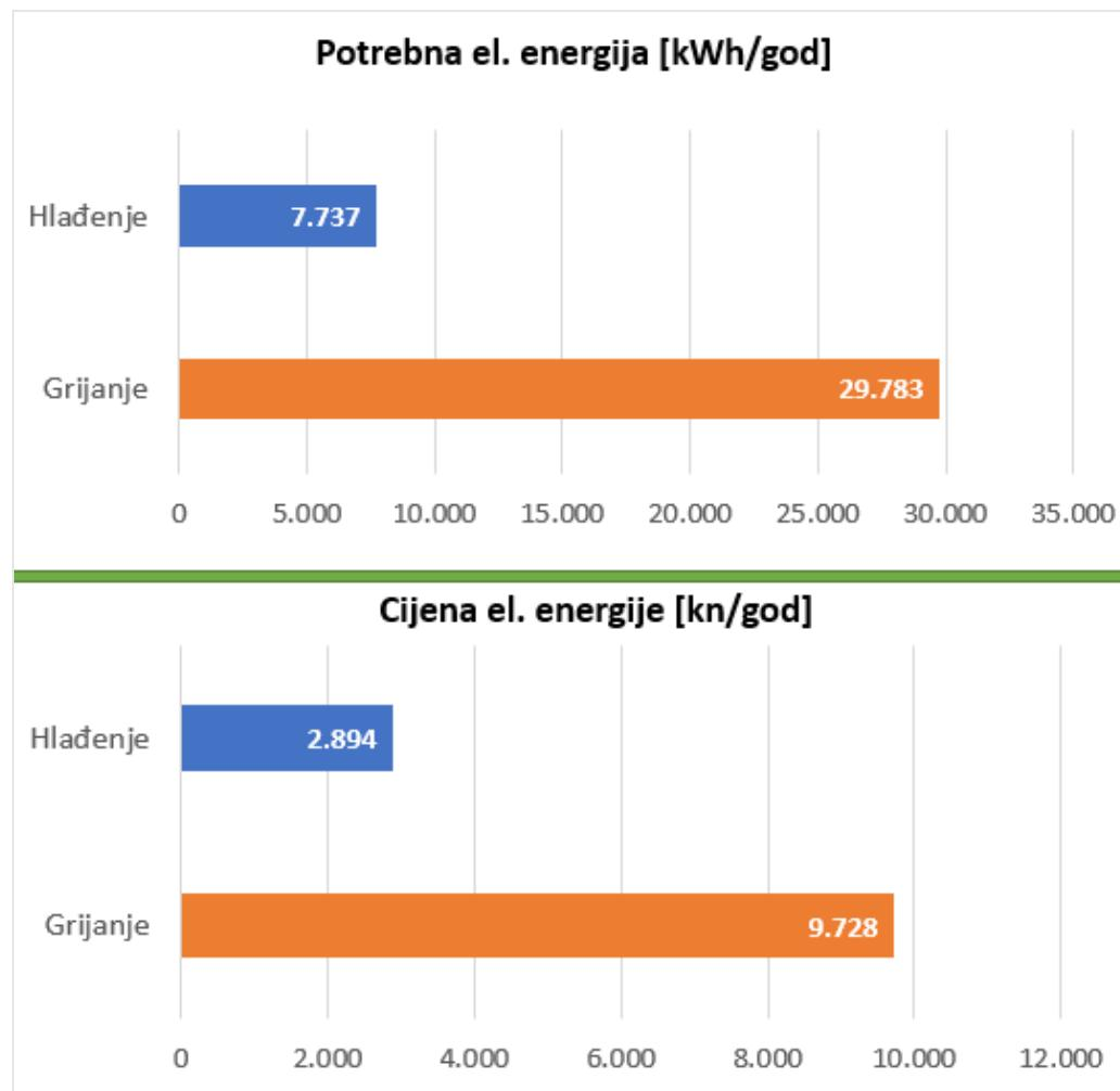
Slika 11. Potrebna isporučena el. energija i pogonski trošak postojećeg stanja zgrade
