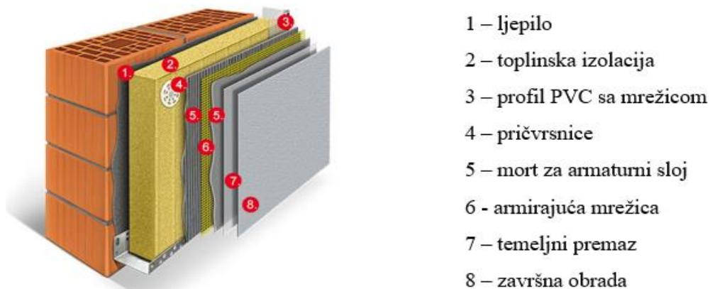
Slika 17. Slojevi fasade i potrebnii elementi za pravilno postavljanje mineralne vune [8]
