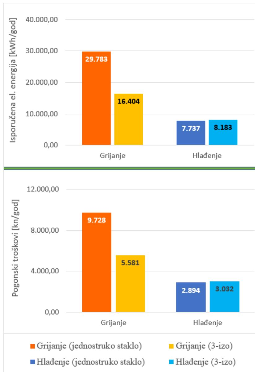
Slika 16. Usporedba isporučene el. energije i pogonskih troškova između prozora s jednostrukim stakлом i 3-izo prozora
