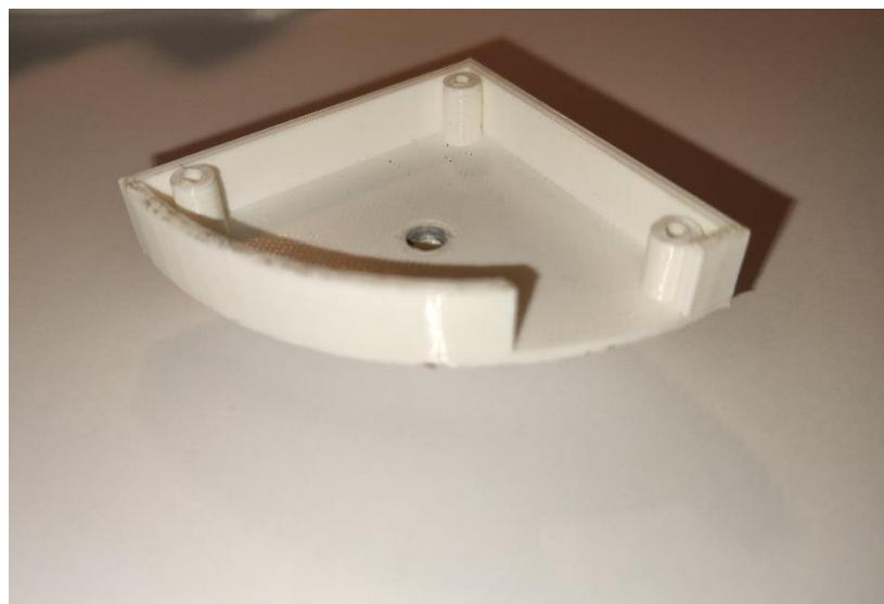
Slika 15 Kućište senzora isprintano
