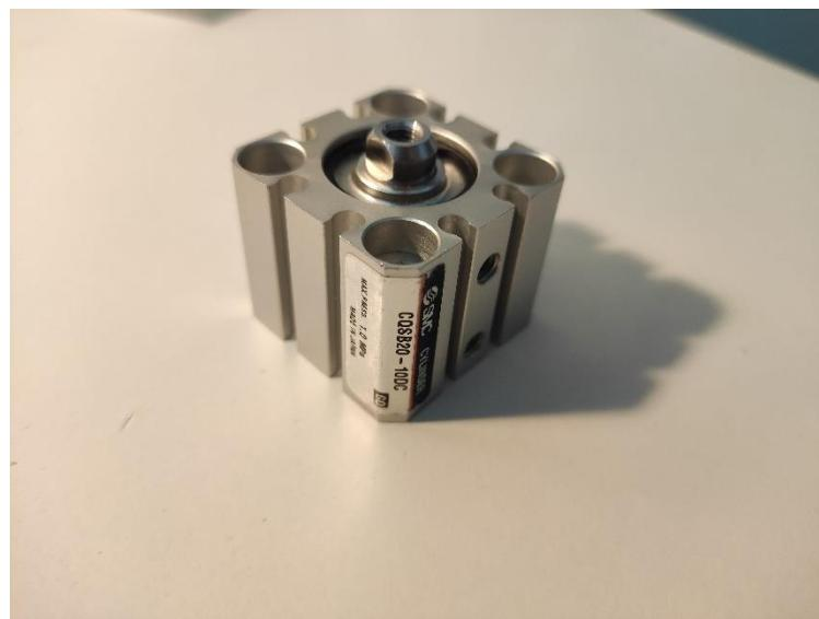
**Slika 1      Minijaturni pneumatski cilindar**
