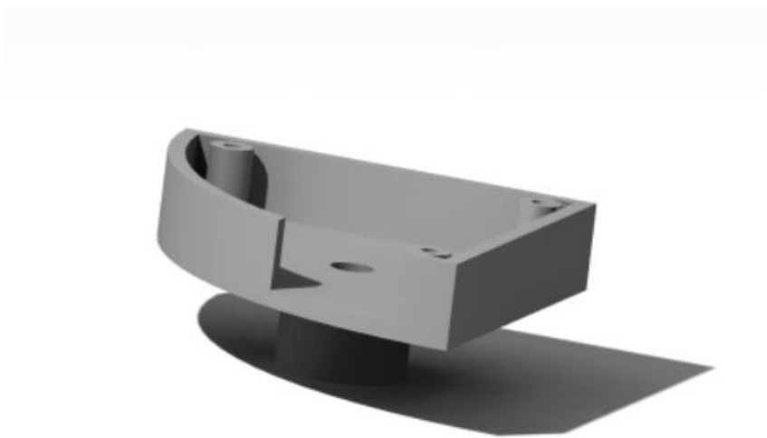
Slika 14 Kućište senzora- CAD model
