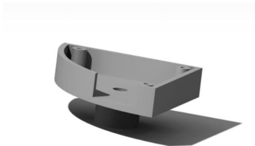
Slika 14 Kućište senzora- CAD model
