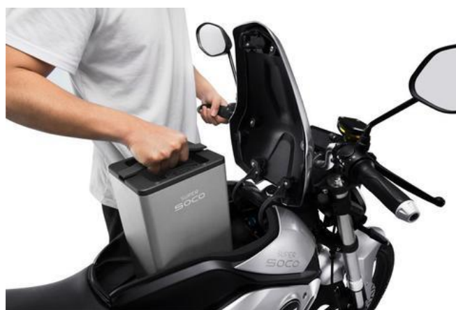
Slika 5. Izmjena baterije na motociklu
