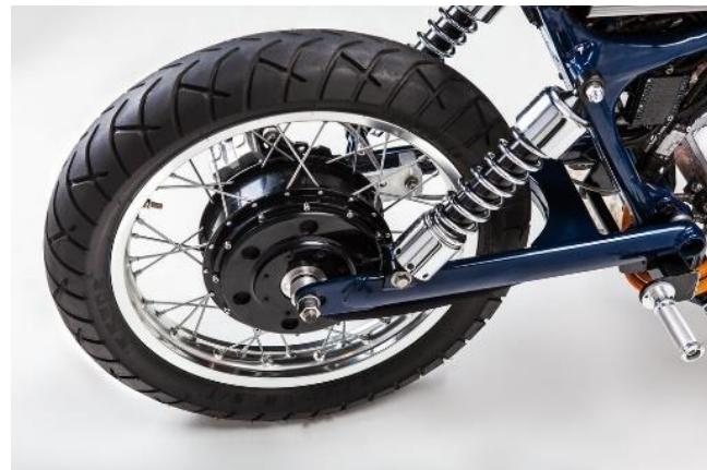
**Slika 10. Elektromotor kao dio pogonskog kotača (Hub-drive)**
