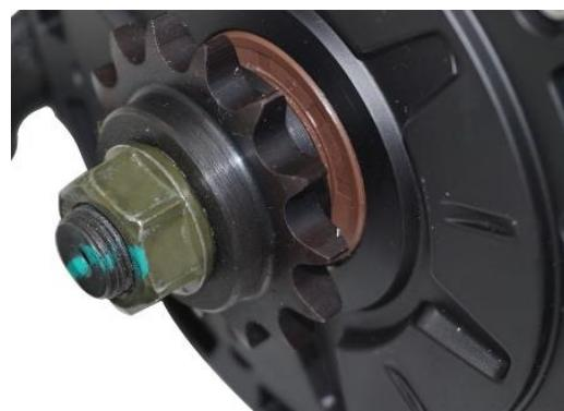
Slika 41. Pogonski lančanik na elektromotoru
