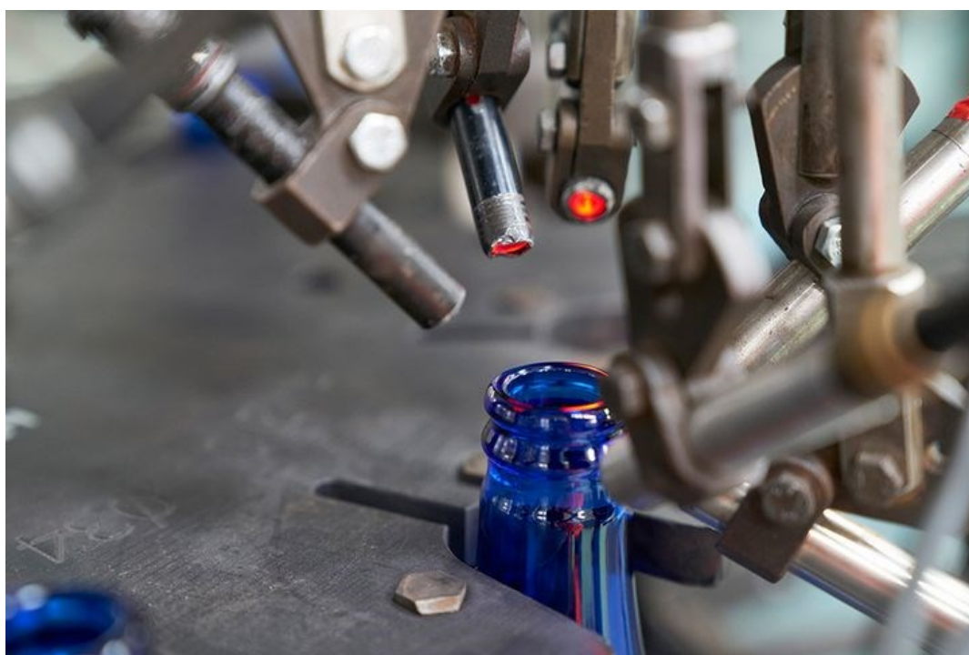
Slika 40. Optička kontrola kvalitete na liniji za formiranje staklene ambalaže [45]
