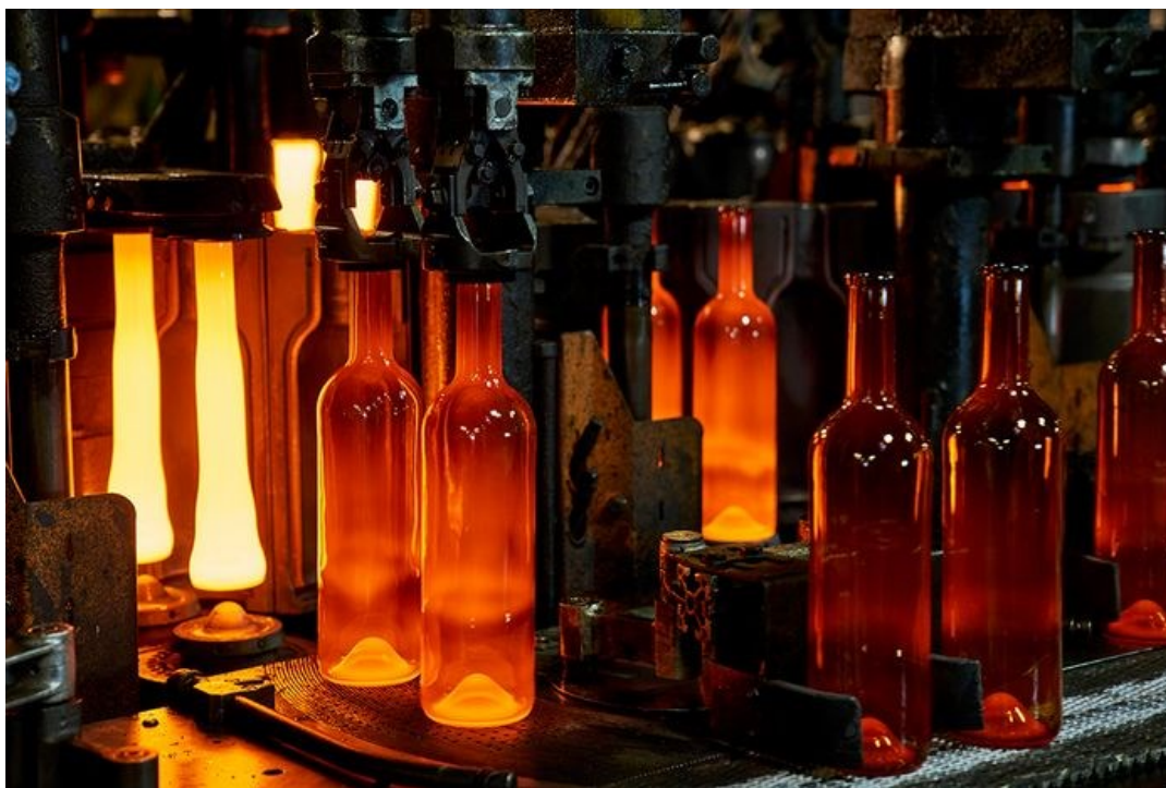
Slika 39. Izgled staklenih spremnika nakon formiranja oblika [45]
