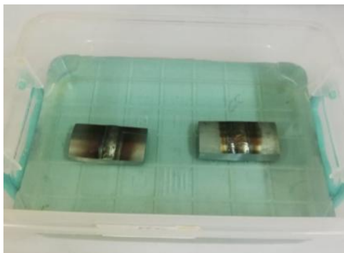
Slika 39. Kemijska obrada nehrđajućih čelika
