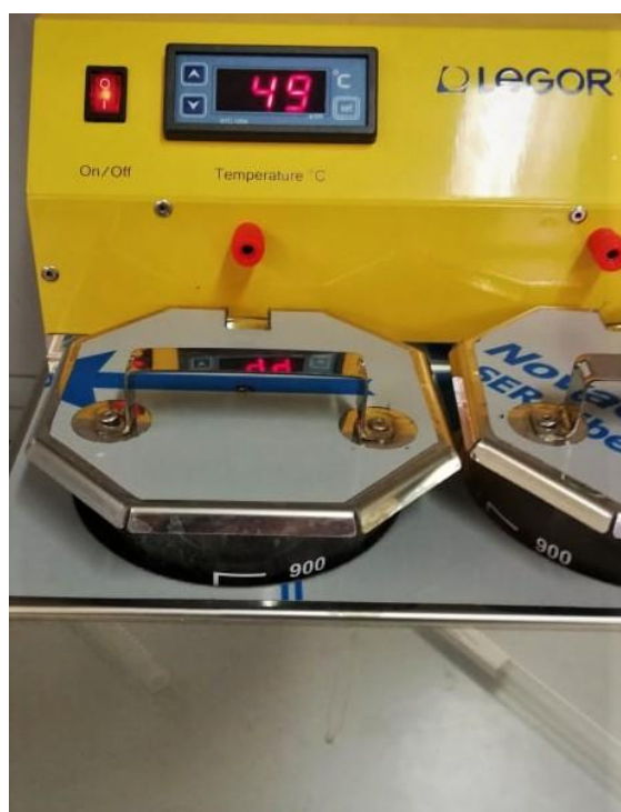
Slika 43. Provedba korozijskog ispitivanja u otopini željezovog (III) klorida na temperaturi od 50 \pm 2^\circ\text{C} prema normi ASTM G48
