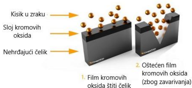
Slika 31. Prikaz oštećenja nehrđajućeg čelika zbog oštećivanja zaštitnog sloja [15]
