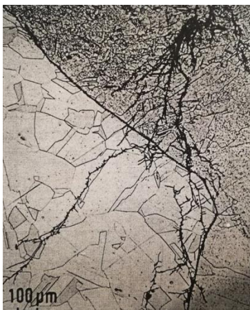
Slika 16. Kloridna napetosna korozija zavarenog spoja [11]
