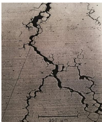
Slika 17. Kaustična napetosna korozija u zoni utjecaja topline [11]
