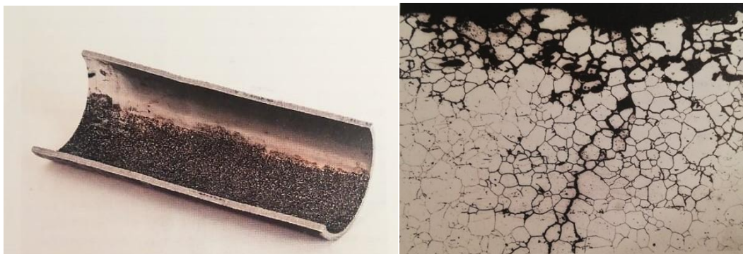
Slika 14. Primjeri interkristalne korozije [10]
