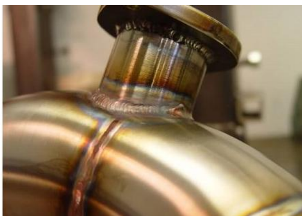
Slika 32. Spektar boja u zoni utjecaja topline nakon zavarivanja nehrđajućeg čelika [15]
