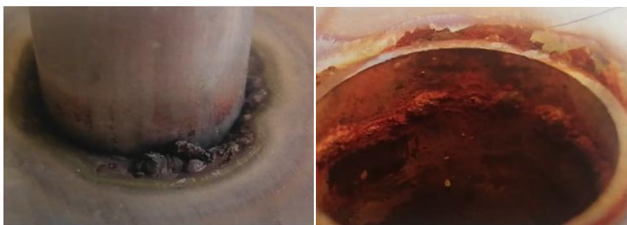
Slika 34. Progaranje oksida sa korijenaste strane u cijevi nakon TIG zavarivanja bez pomoćnog plina [14]
