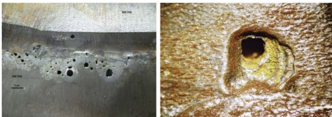
Slika 27. Rupičasta korozija u zoni utjecaja topline zavarene cijevi [13]
