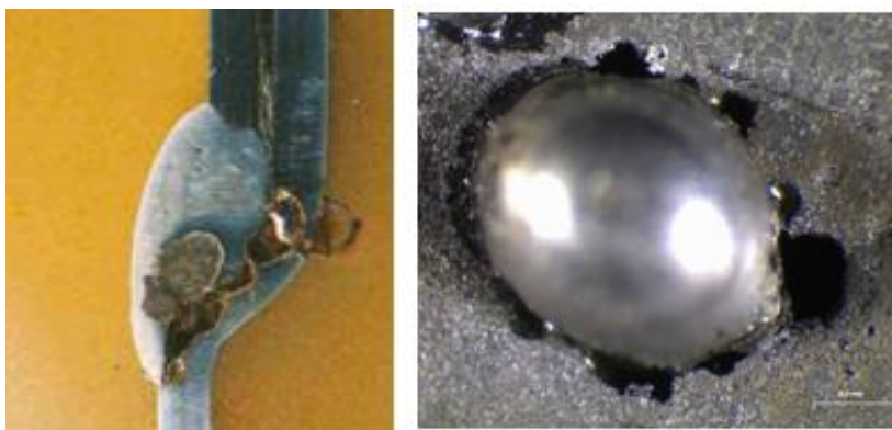
Slika 18. Korozija u procijepu preklopnog zavarenog spoja i ispod kapi metala naštrcane pri zavarivanju [2]
