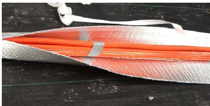
Slika 4.3. Izolacija cijevi za toplu vodu
