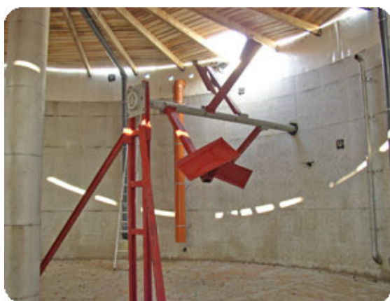
Slika 2.27. Miješalica s horizontalnom osovinom
