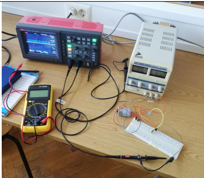
Slika 24. Ispitivanje karakteristika enkodera
