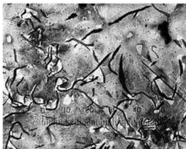
Slika 13. Mikrostruktura sivog lijeva
