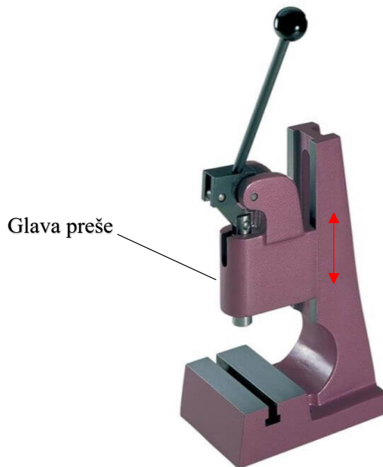
Slika 9. Ručna preša sa zglobnom polugom
