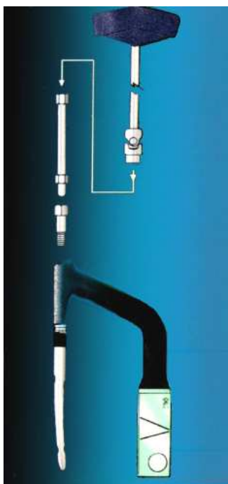
Slika 2.16 Prikaz montiranja čavla u vodilici za uvađanje [1]
