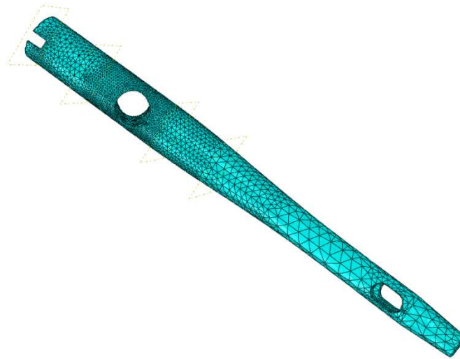
Slika 6.15 Prikaz mreže konačnih elemenata čavla
