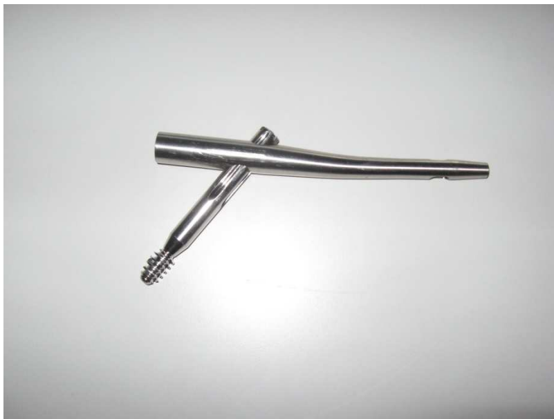
Slika 4.10 Gama čavao nakon dinamičkog eksperimenta
