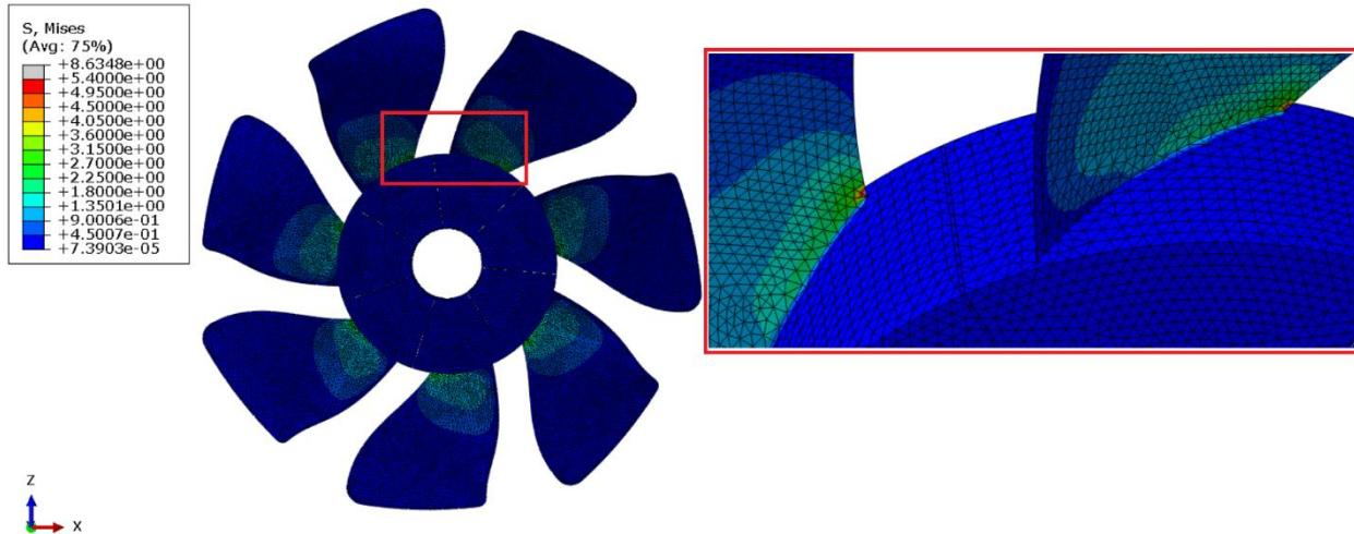
**Slika 52.** Naprezanja prema von Misesu u MPa pri prikazu unutarnje strane modela ventilatora
