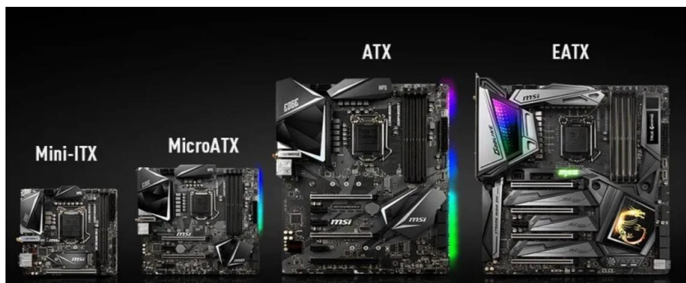
Slika 9. Prikaz matičnih ploča prema faktoru oblika [11]
