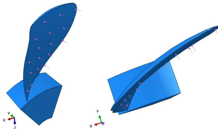
**Slika 47. Opterećenje modela lopatice tlakom s unutarnje strane**
