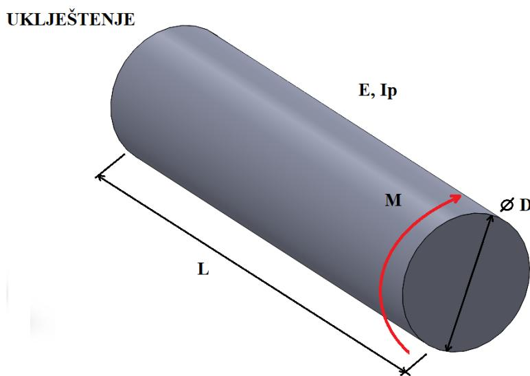
Slika 23. Prikaz modela konzole grede opterećene na uvijanje
