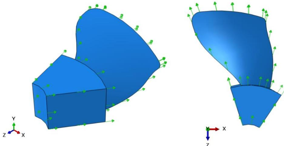
**Slika 46. Opterećenje modela lopatice centrifugalnom silom**
