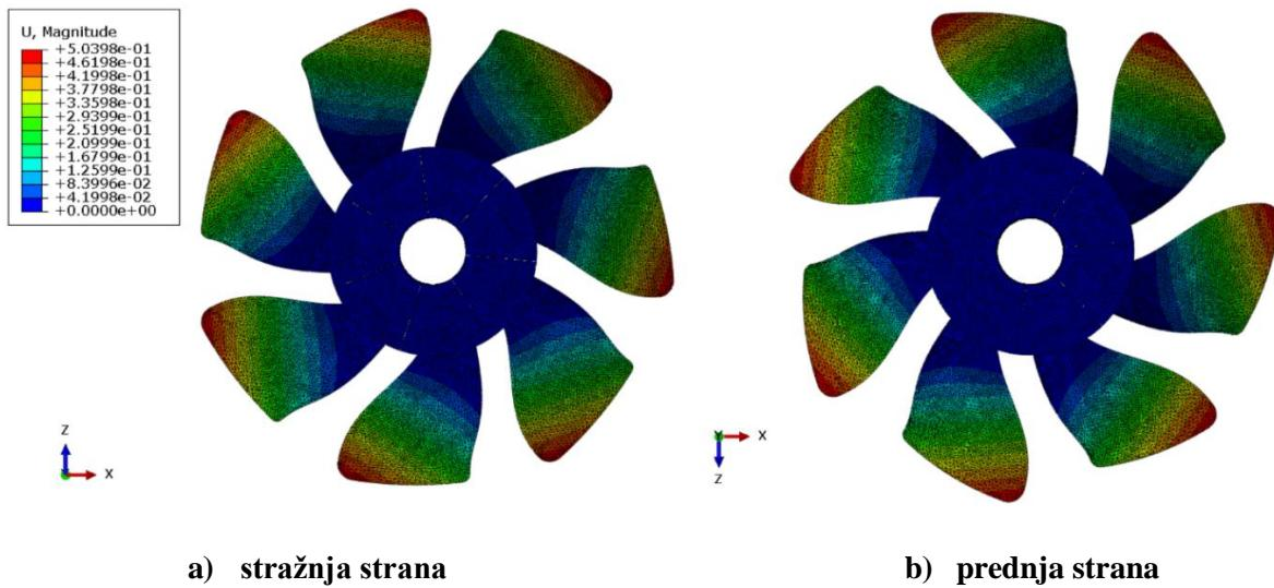
Slika 55. Pomaci u mm pri prikazu cijelog modela ventilatora
