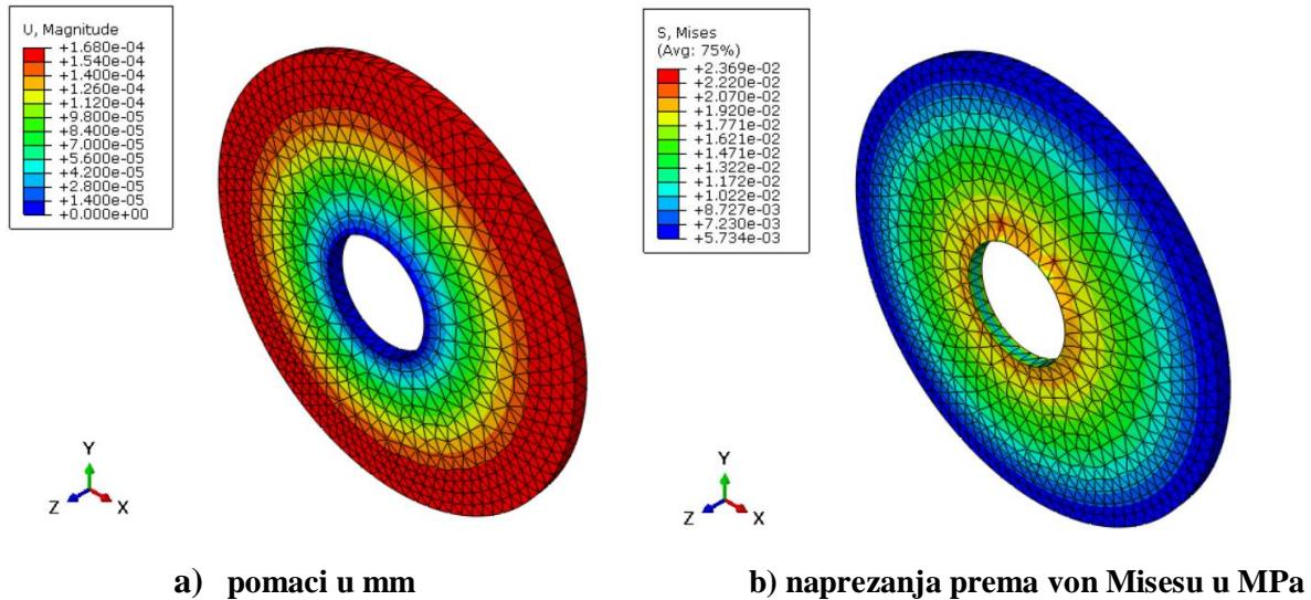
Slika 33. Rezultati numeričke analize kružnog diska za mrežu od 7577 konačnih elemenata
