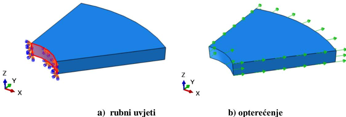
**Slika 38. Prikaz rubnih uvjeta i opterećenja isječka kružnog diska**
