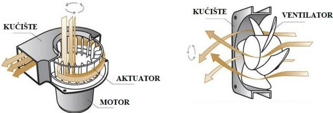
**Slika 3. Prikaz centrifugальног i aksijальног ventilatora [2]**
