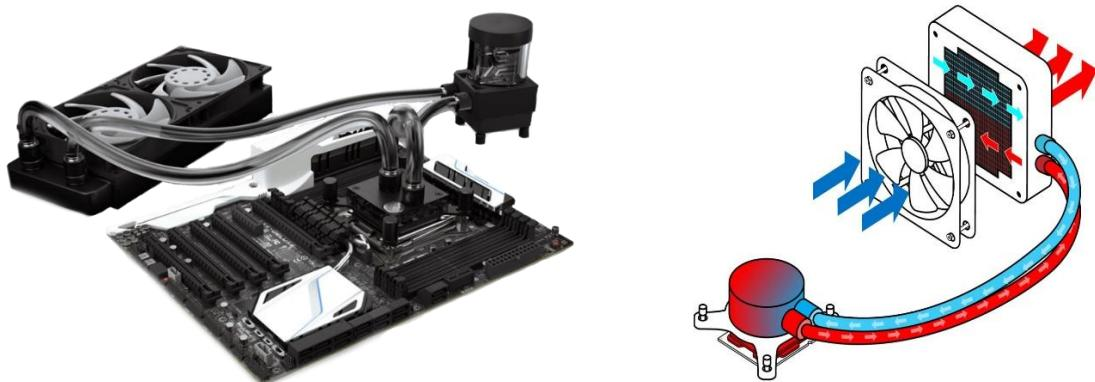
Slika 7. Hladnjak računalnog procesora na bazi vode [2]
