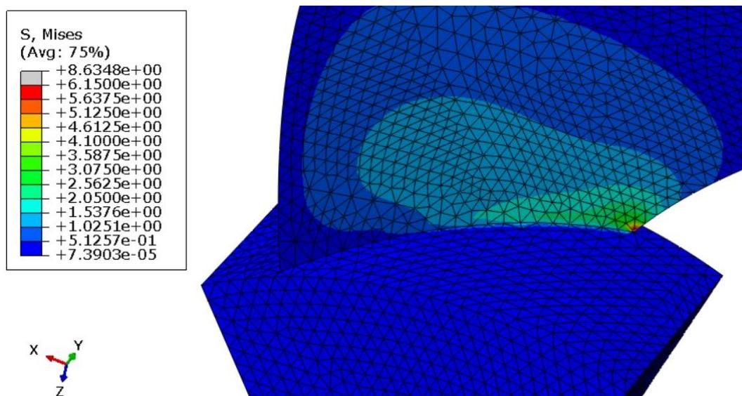
d ) slučaj opterećenja tlaka 21 Pa te brzine vrtnje 209.45 rad/s
