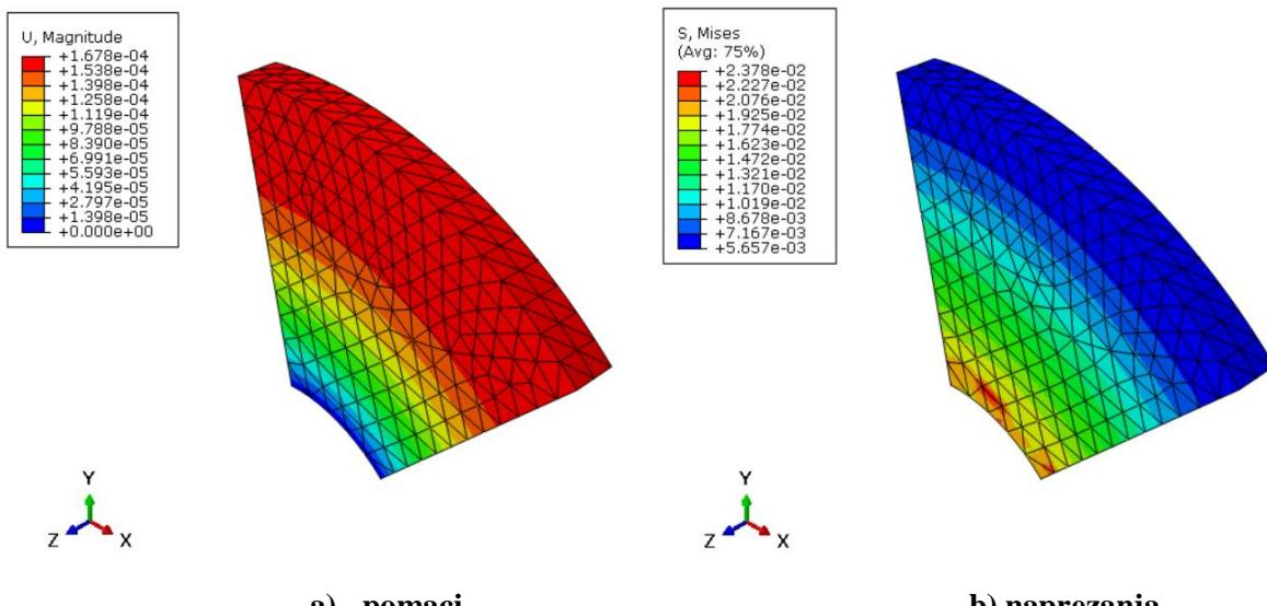
**Slika 39.** Rezultati pomaka u mm i naprezanja prema von Misesu u MPa isječka diska
