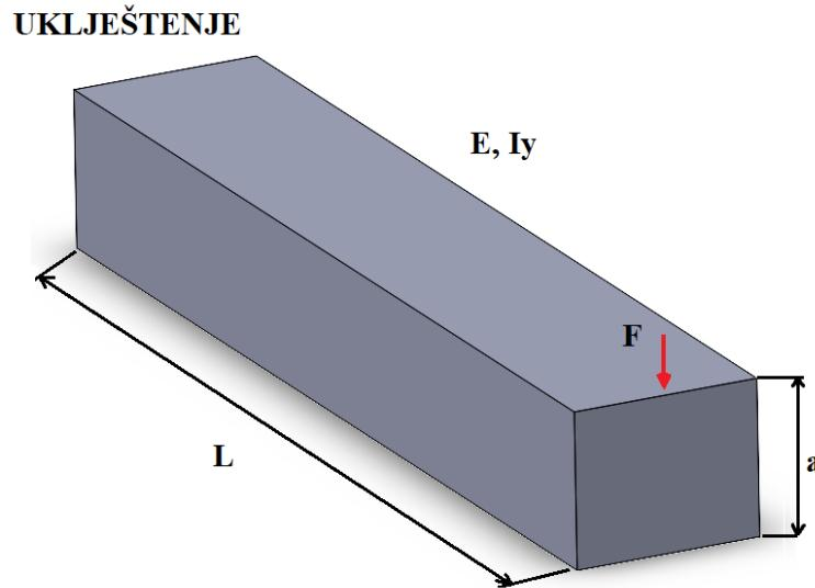
Slika 17. Prikaz modela konzole grede opterećene na savijanje
