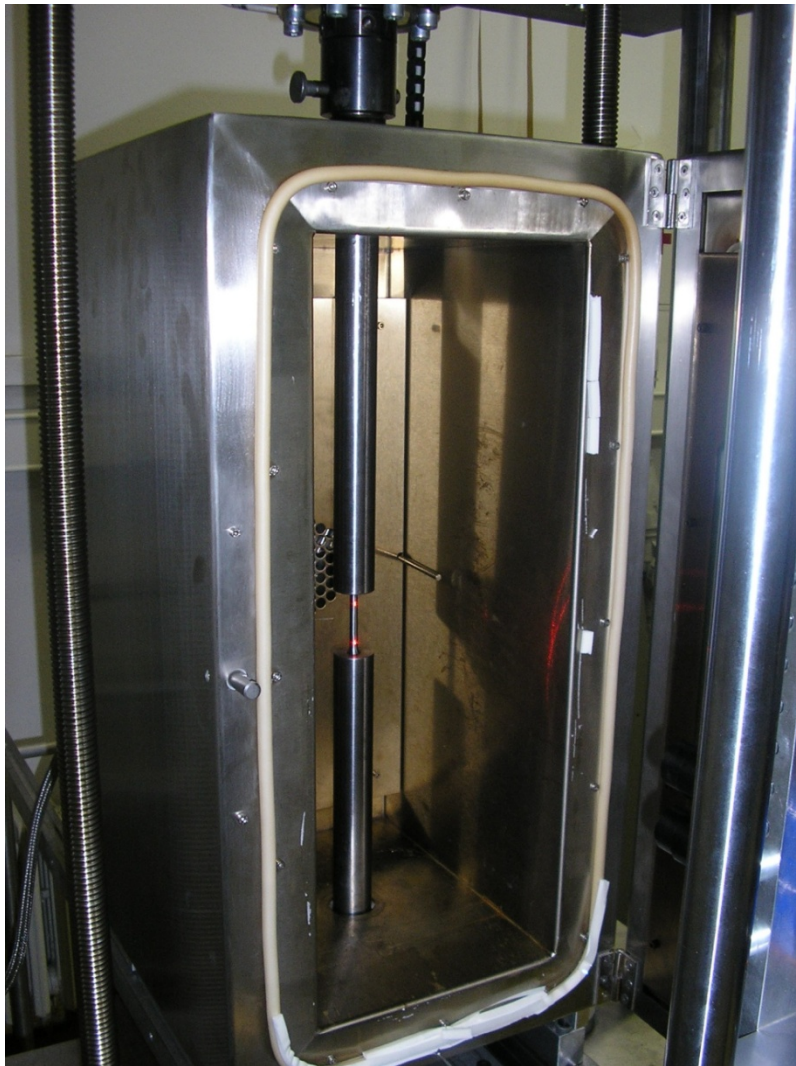
Slika 5.8 Epruveta učvršćena u navojne šipke
