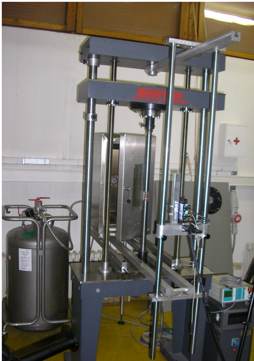
Slika 5.1 Statička kidalica Messphysik Beta 50-5
