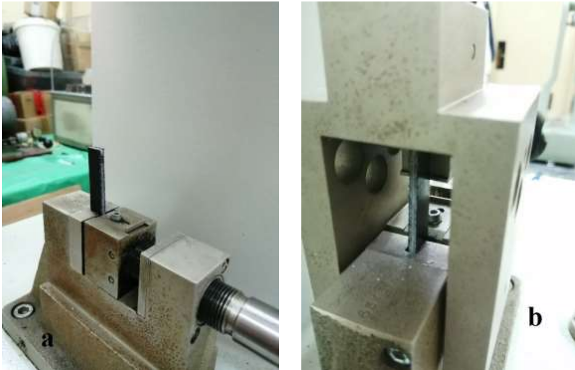
Slika 6.24. Ispitivanje žilavosti po Izodu: a) ispitno tijelo u čeljustima, b) udar bata u ispitno tijelo
