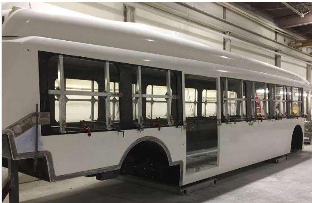
Slika 3.5. Završena monocoque samonosiva šasija modela Catalyst od proizvođača Proterra [20]
