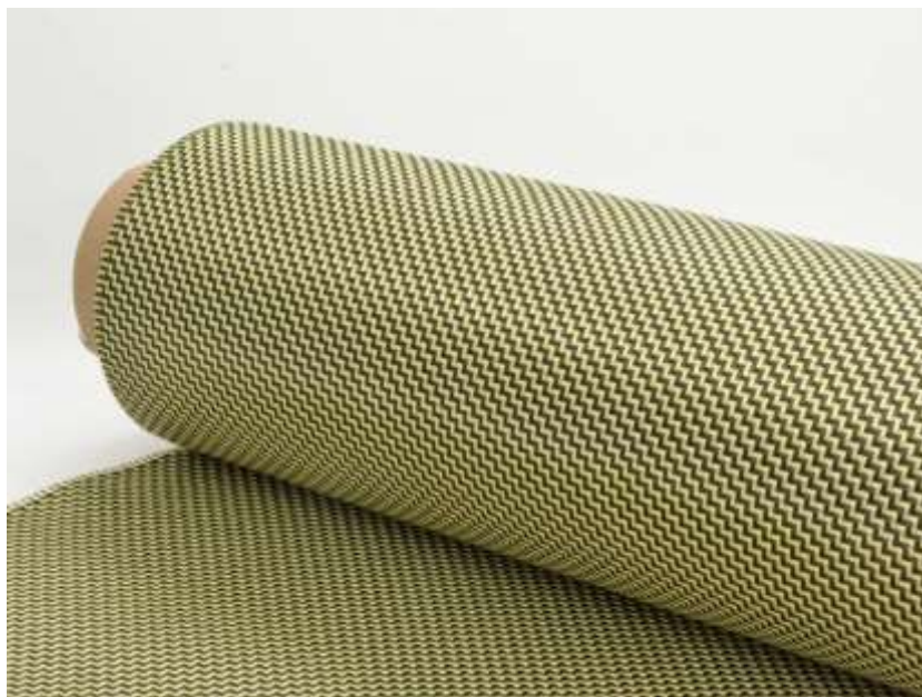
Slika 2.8. Hibridna tkanina, ugljična i aramidna vlakna [38]
