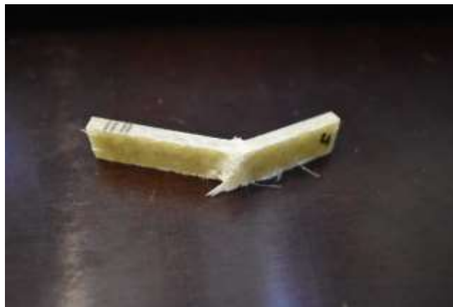
Slika 6.39. Oštećenje ispitnog tijela M-S-4 uslijed ispitivanja
