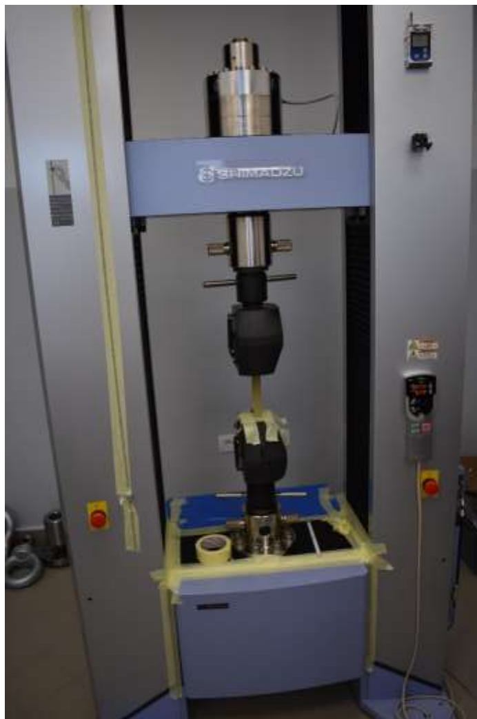
Slika 6.28. Kidalica Shimadzu AG-X plus
