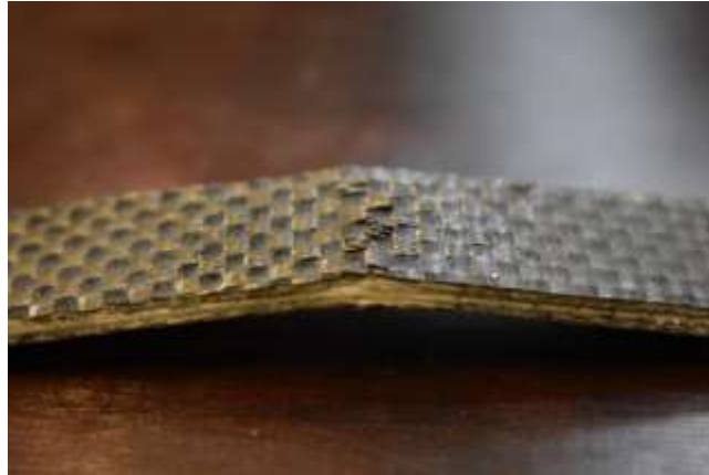
Slika 6.38. Oštećenje ispitnog tijela UMT-S-2 uslijed ispitivanja
