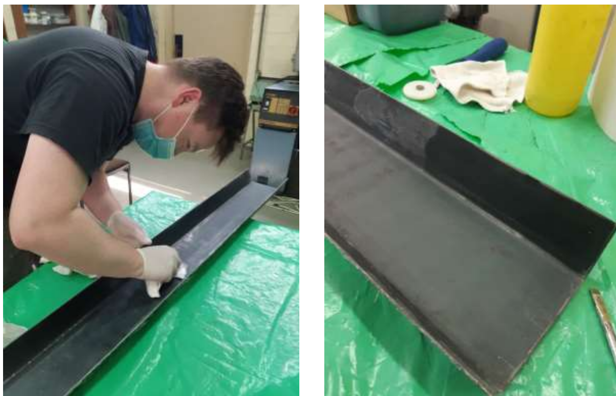
Slika 6.4 Nanošenje i poliranje odvajala
