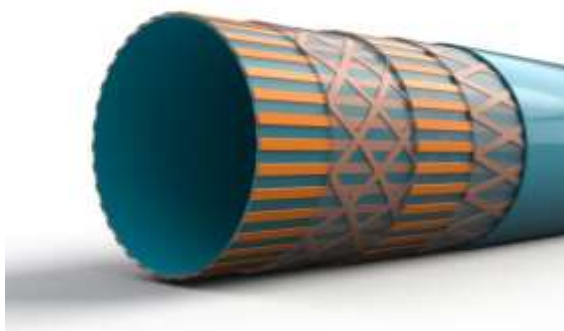
Slika 4.8. Princip pullwinding postupka tvrtke EXEL [27]
