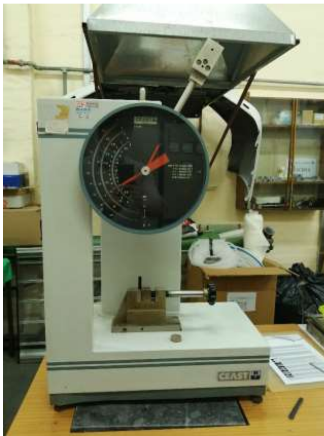
Slika 6.23. Uređaj za ispitivanje žilavosti po Izodu
