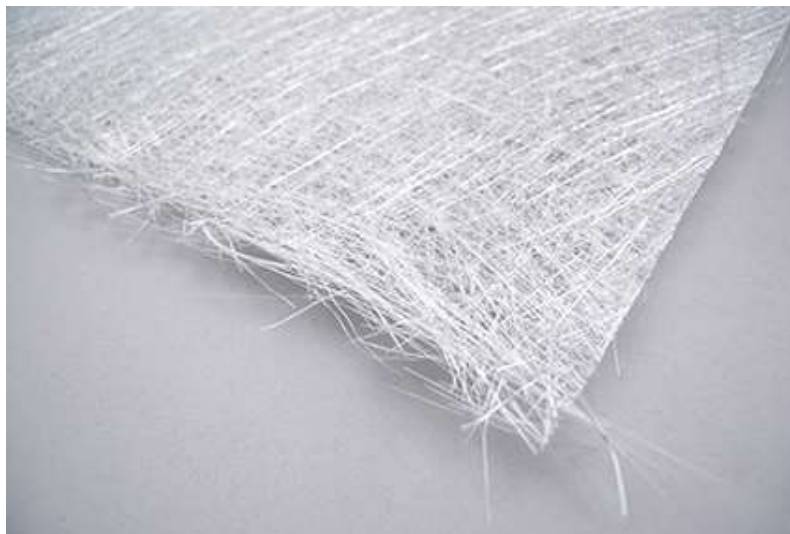
Slika 2.5. Mat staklenih vlakana proizvođača Hacotech [11]
