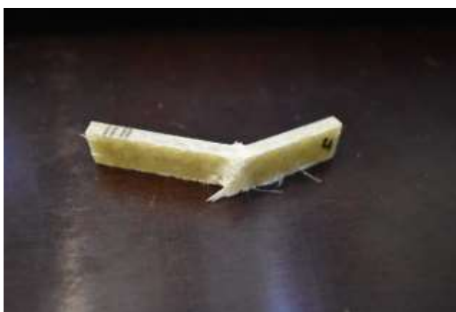
Slika 6.38. Oštećenje ispitnog tijela UMT-S-2 uslijed ispitivanja
