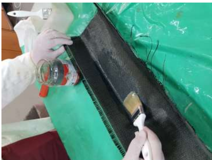
Slika 6.8. Impregnacija prvog sloja profila 3
