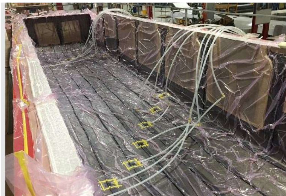
Slika 3.6. Proizvodnja gornjeg dijela šasije SCRIMP postupkom [20]
