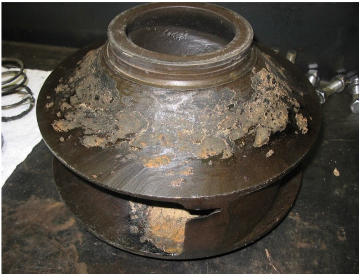
Slika 17. Rotor pumpe oštećen kavitacijom [7]
