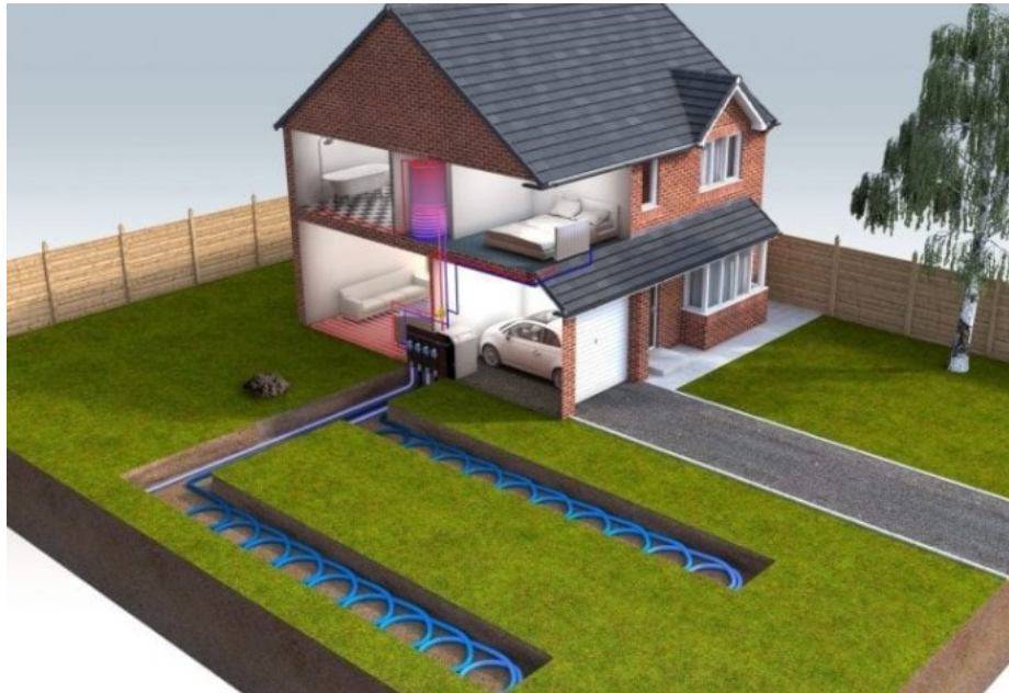
Slika 7. Horizontalno polaganje izmjenjivača topline [9]
