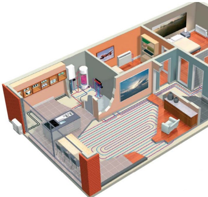
Slika 9. Shematski prikaz sustava zrak-voda dizalice topline [10]
