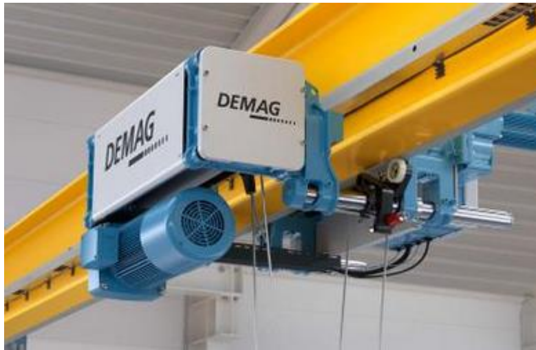
Slika 6. Mosni granik izrađen od standardnih profila[4]
