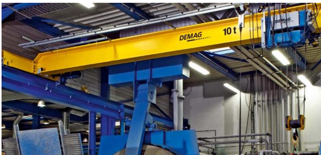
Slika 4. Mosni granik sa jednim glavnim nosačem [2]
