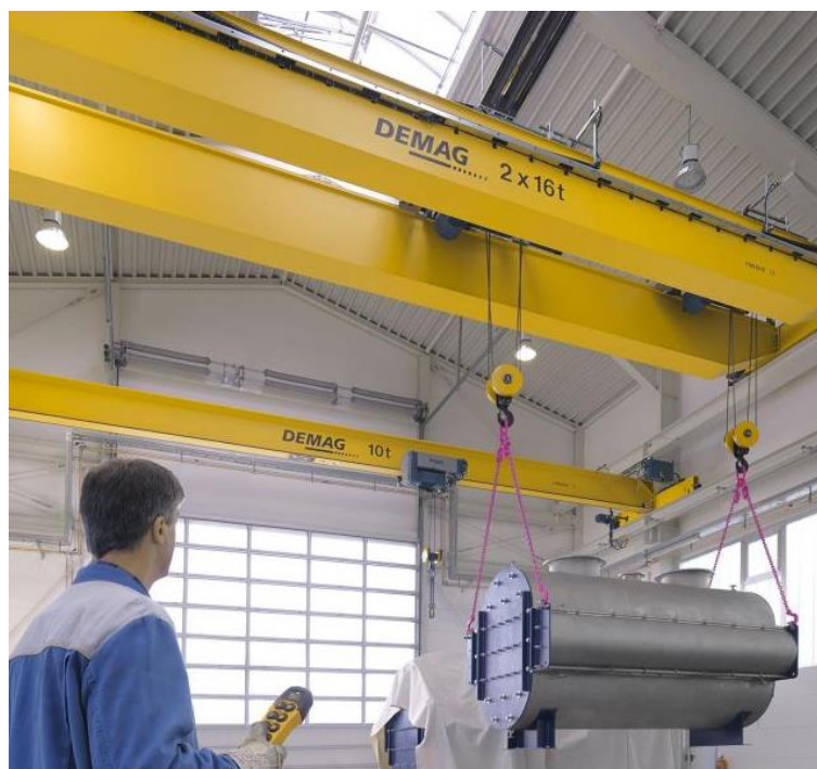
Slika 7. Glavni nosači izrađeni od limova[6]
